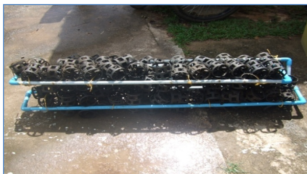
ภาพที่ 3-41 ตัวกลางระบบบำบัดอาคารผู้ป่วยใน
