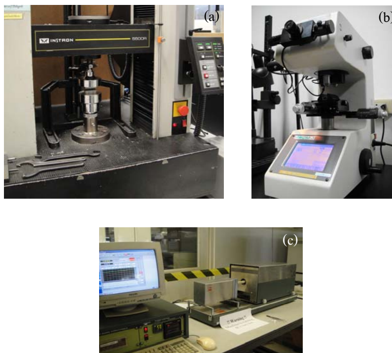
รูปที่ 2.4 เครื่องมือและอุปกรณ์ที่ใช้ในการทดสอบสมบัติเชิงกลและเชิงความร้อน (a) Bending Machine (b) Vicker Hardness Tester และ (c) Dilatometer
