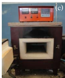
รูปที่ 2.1 เครื่องมือและอุปกรณ์ที่ใช้ในการสังเคราะห์ (a) SHS Reactor (b) Planetary Ball Mill (c) Low Temperature Furnace (d) Hydraulic Press และ (e) Cylindrical Tool Steel Mould
