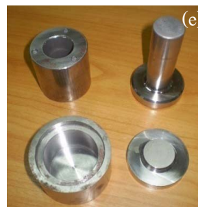
รูปที่ 2.1 เครื่องมือและอุปกรณ์ที่ใช้ในการสังเคราะห์ (a) SHS Reactor (b) Planetary Ball Mill (c) Low Temperature Furnace (d) Hydraulic Press และ (e) Cylindrical Tool Steel Mould
