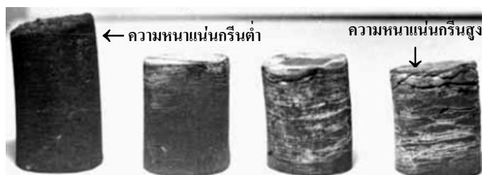
รูปที่ 1.20 ชิ้นงาน \text{WO}_3/\text{Zn} หลังกระบวนการ SHS ที่มีค่าความหนาแน่นกรีนต่างกัน (Lee et al. 2001)
