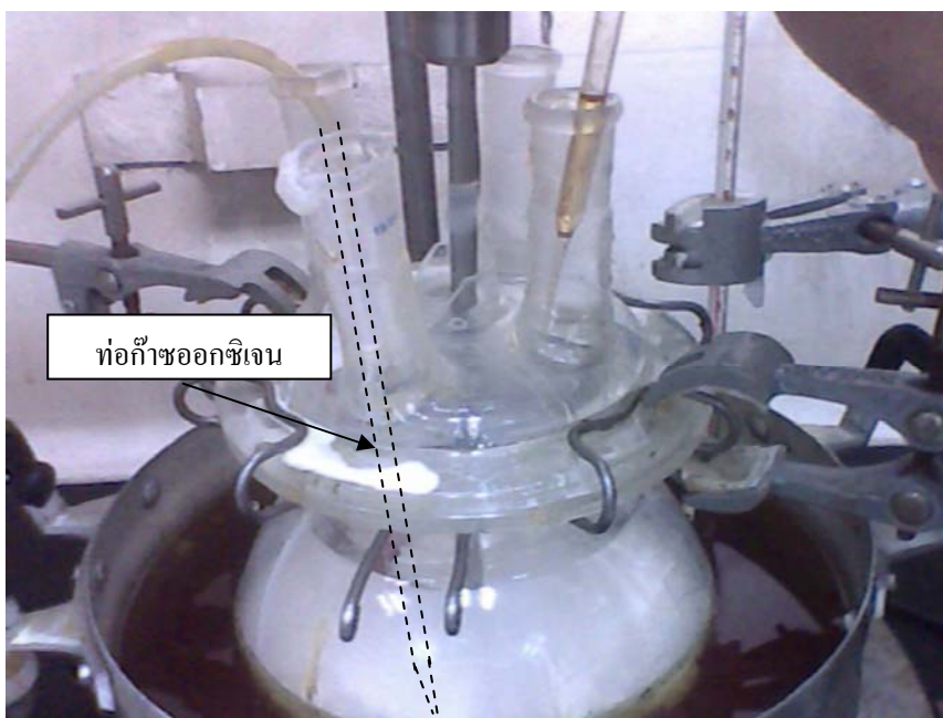
รูปที่ 3.3 หม้อทำปฏิกิริยาสำหรับการลดน้ำหนักโมเลกุลยาง
