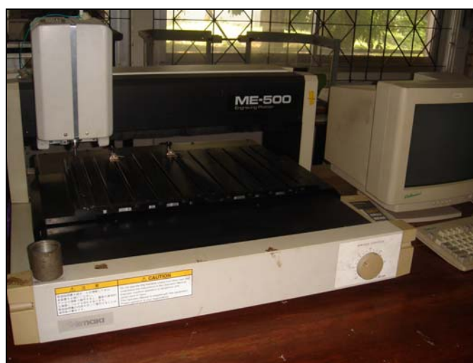
ภาพที่ 3.4 เครื่องกัดลาย CNC Engraving plotter
