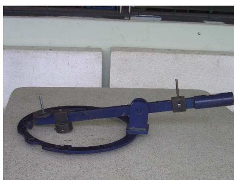
รูปที่ 4.5 อุปกรณ์ทดสอบหาค่าความต้านทานต่อการสึกหรอ
