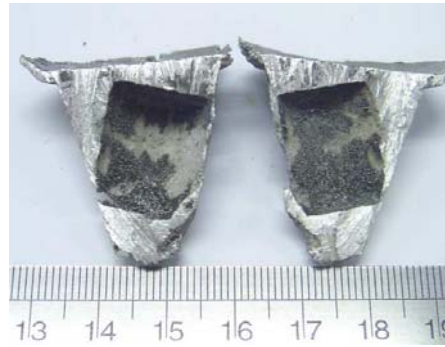
รูปที่ 5.21 ลักษณะชิ้นงานวัสดุผสมเนื้ออะลูมิเนียม ที่ได้จากการทดลองวิจัยหลังผ่านการตัดและขัดให้เรียบ ธรรมชาติขนาดอนุภาคผงซิลิคอนคาร์ไบด์ 100 \mu\text{m} ความดันน้ำโลหะอะลูมิเนียมเหลว 0.15 MPa
