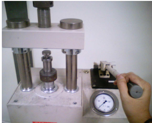
รูปที่ 4.17 การนำชุดอุปกรณ์การอัดชิ้นงานที่อยู่ในบรรจุภัณฑ์สุญญากาศไปเข้าเครื่องอัดไฮดรอลิกส์
