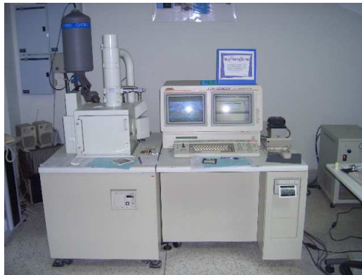
รูปที่ 4.8 กล้องจุลทรรศน์อิเล็กตรอนแบบส่องกราด
