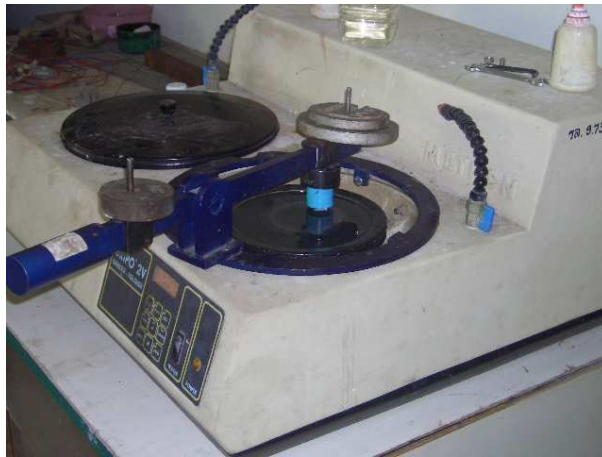
รูปที่ 4.27 การนำชิ้นงานมาประกอบกับอุปกรณ์ทดสอบหาค่าความต้านทานต่อการสึกหรอและ จับยึดกับเครื่องขัดแบบจานคู่ พร้อมกับการถ่วงด้วยโหลدن้าหนัก 1.5 kg
