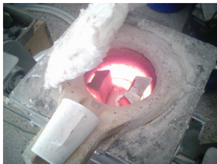
รูปที่ 4.20 การหลอมแท่งอะลูมิเนียมเกรด A356 ในเตาหลอมโลหะชนิดขดลวดความต้านทาน
