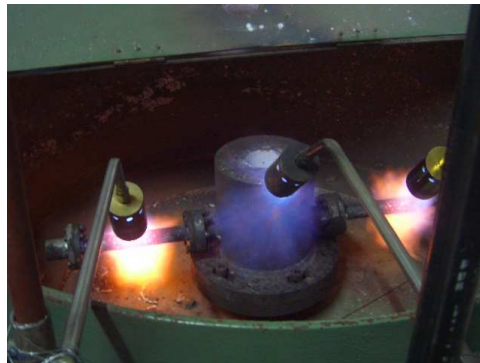
รูปที่ 4.21 การใช้ไฟเผาอุ่นชุดระบบการหล่อเหวี่ยงความดันสูง
