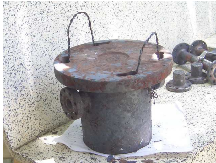
รูปที่ 4.23 การรื้อยลวดโลหะเหล็กขนาดใหญ่เข้าสู่รูสลักเกลียวที่ฐานของชิ้นส่วนที่รองรับน้ำโลหะเพื่อเป็นหูหิ้ว
