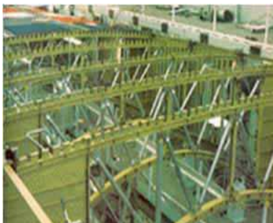
รูปที่ 2.2 โครงสร้างกึ่งกลางลำตัวของกระสวยอวกาศซึ่งแสดงให้เห็นถึงท่อ โลหะผสม โบรอน และอะลูมิเนียม
