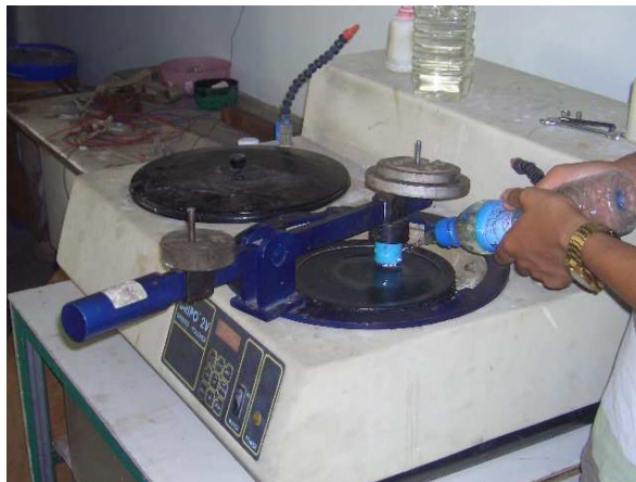
รูปที่ 4.28 เปิดเครื่องขัดแบบจานคู่ทำการขัดกับกระดาษทราย เบอร์ 150 C.C. ใช้โหลدن้าหนัก ถ่วง 1.5 kg ความเร็วในการหมุนขัด 252 rpm พร้อมฉีดน้ำเพื่อการหล่อลื่น
