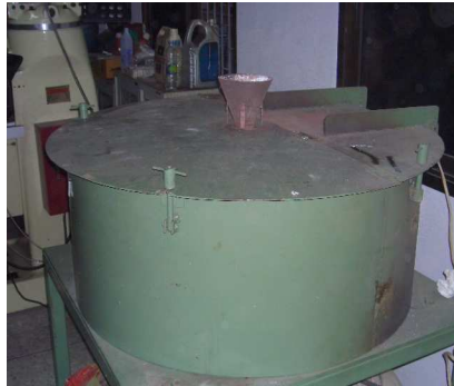
รูปที่ 4.22 การปิดล็อกฝาเครื่องหล่อเหวี่ยงและวางกรวยประคองน้ำโลหะ เพื่อป้องกันอันตรายจากการหล่อเหวี่ยงด้วยความดันสูง
