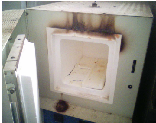
รูปที่ 4.18 การนำวัตถุดิบผสมที่อัดขึ้นรูปแล้วนำเข้าเตาเผาที่อุณหภูมิ 1,000 °C เป็นเวลา 4 ชั่วโมง
