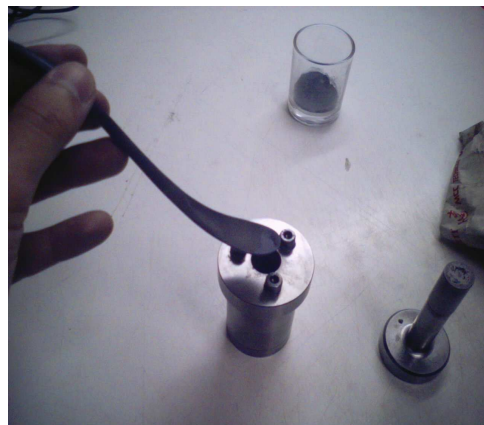
รูปที่ 4.16 การตัดวัตถุดิบผสม (ผงซิลิคอนคาร์ไบด์ผสมกับน้ำ) ใส่ลงในชิ้นส่วนเข้าอัดขึ้นงาน
