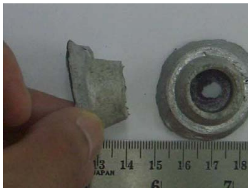
รูปที่ 5.22 ลักษณะชิ้นงานวัสดุผสมเนื้ออะลูมิเนียม ที่ได้จากการทดลองวิจัยหลังผ่านการตัดและขัดให้เรียบ ธรรมชาติขนาดอนุภาคผงซิลิคอนคาร์ไบด์ 100 \mu\text{m} ความดันน้ำโลหะอะลูมิเนียมเหลว 0.19 MPa
