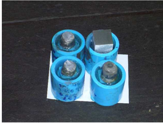
รูปที่ 4.26 การนำชิ้นงานมาทำการหล่อเรซินกับท่อประปาพีวีซี
