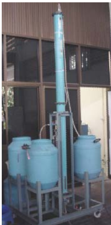
รูปที่ 3.4 สเปรย์คอลัมน์แบบ 3 คอลัมน์วางตัวในแนวตั้งผลิตจากท่อพีวีซี
