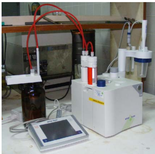
รูปที่ 3.7 เครื่องไตเตรทอัตโนมัติสำหรับวัดค่า pH
