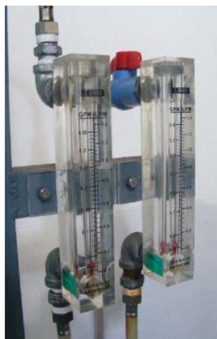
รูปที่ 3.6 flow meter สำหรับวัดอัตราการไหล
