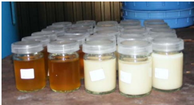
รูปที่ 8 ลักษณะตัวอย่างของไบโอดีเซลหลังการล้าง
