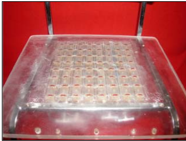
ภาพประกอบ 1-2 ลักษณะการจัดวางตัวตรวจรู้ Electro-pneumatic cells [2]
