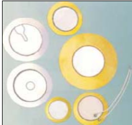
ภาพประกอบ 2-18 ลักษณะของเป็ยโซอิเล็กทริกขนาดต่างๆ
