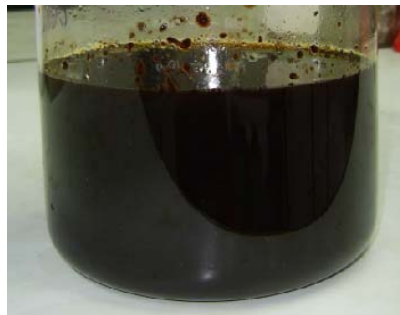
ภาพประกอบที่ 2-1 กลีเซอรอลดิบ (Crude Glycerol) ที่ได้จากกระบวนการผลิตไบโอดีเซล
