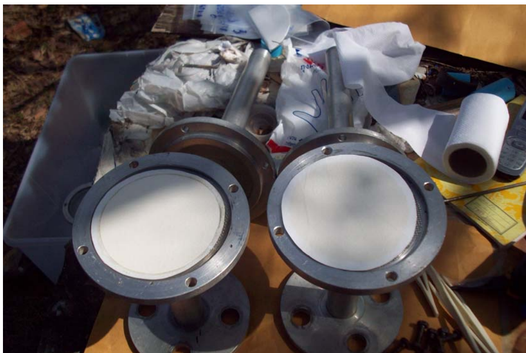
กระดาษกรองที่ผ่านการทดสอบที่ทางเข้า (ซ้าย) และที่ทางออก (ขวา) ในการทดสอบครั้งที่ 10
