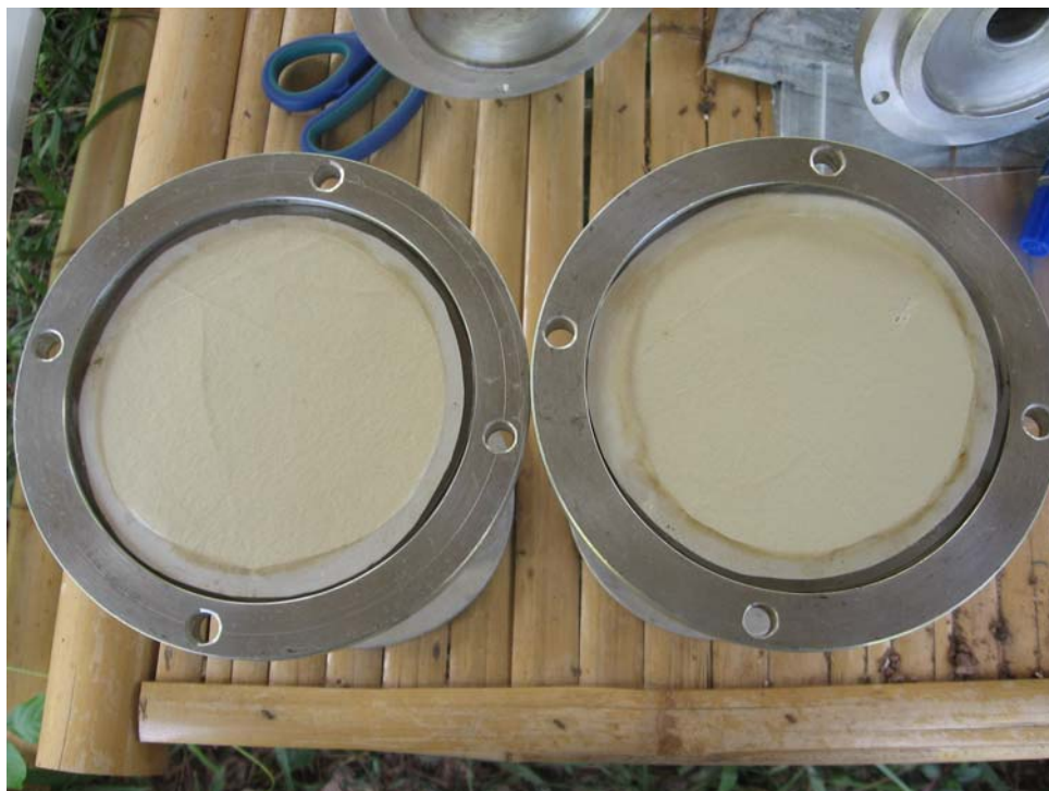
กระดวยกรองที่ผ่านการทดสอบที่ทางเข้า (ซ้าย) และที่ทางออก (ขวา) ในการทดสอบครั้งที่ 10
