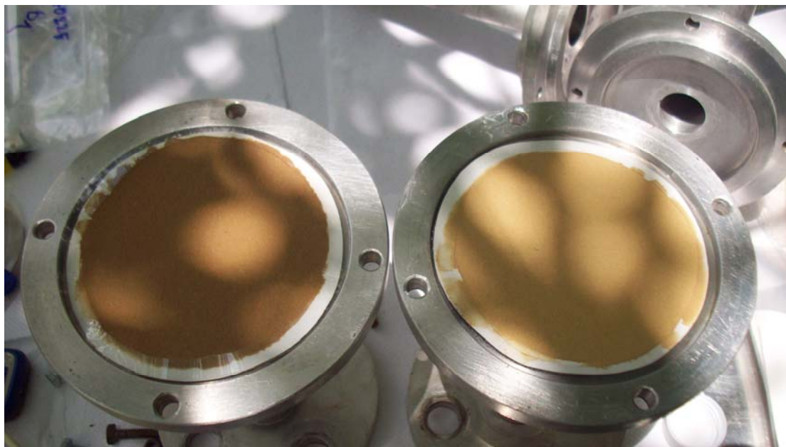
กระดวยกรองที่ผ่านการทดสอบที่ทางเข้า (ซ้าย) และที่ทางออก (ขวา) ในการทดสอบครั้งที่ 6
