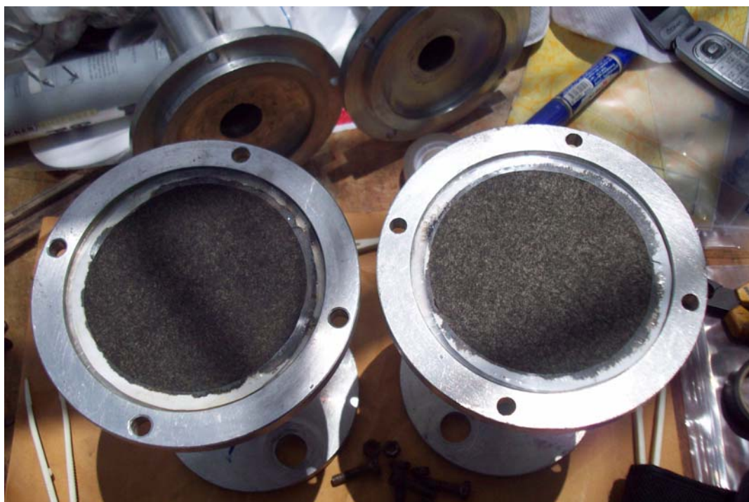
กระดวยกรองที่ผ่านการทดสอบที่ทางเข้า (ซ้าย) และที่ทางออก (ขวา) ในการทดสอบครั้งที่ 2
