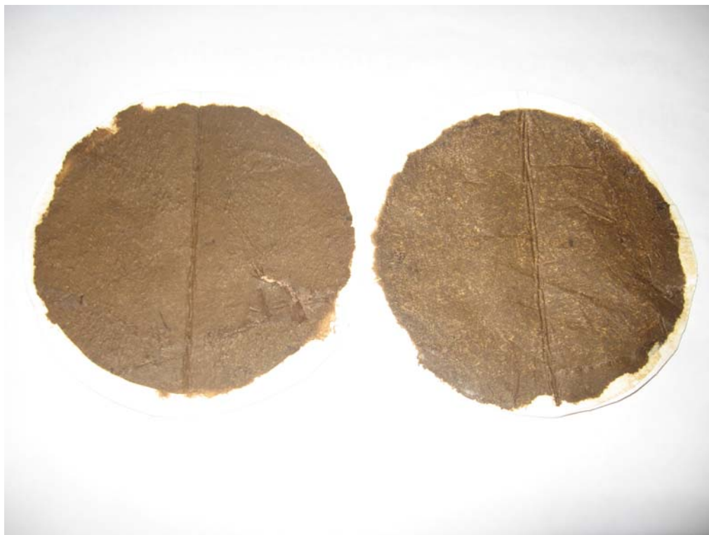
กระดาษกรองที่ผ่านการทดสอบที่ทางเข้า (ซ้าย) และที่ทางออก (ขวา) ในการทดสอบครั้งที่ 8
