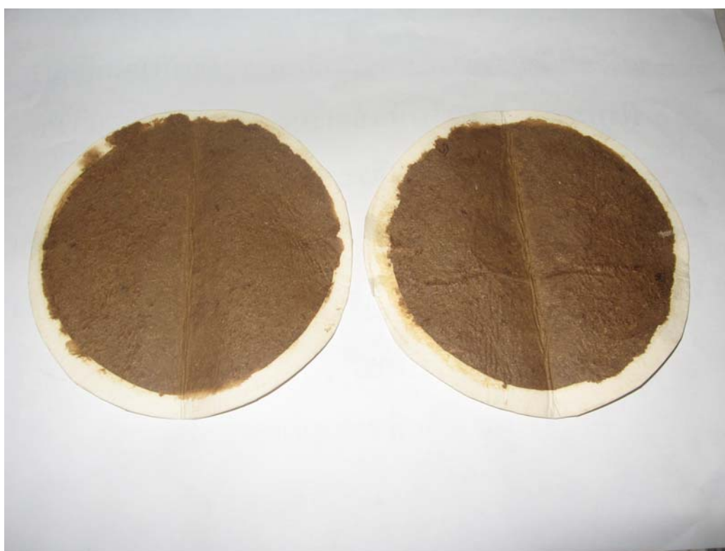
กระดวยกรองที่ผ่านการทดสอบที่ทางเข้า (ซ้าย) และที่ทางออก (ขวา) ในการทดสอบครั้งที่ 1
