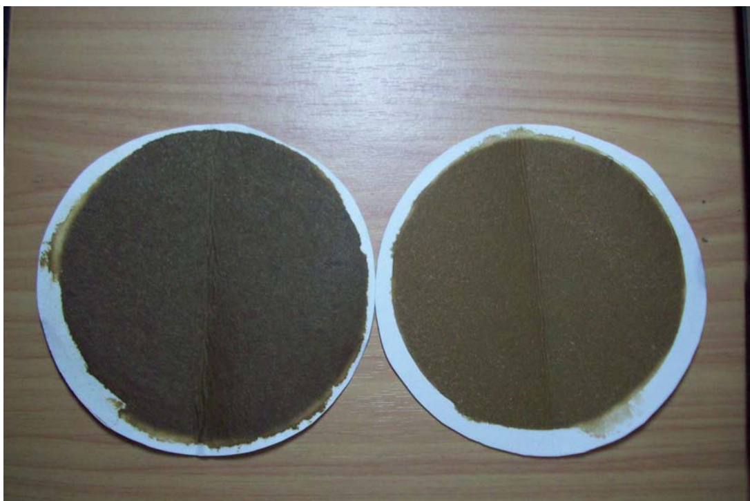
กระดวยกรองที่ผ่านการทดสอบที่ทางเข้า (ซ้าย) และที่ทางออก (ขวา) ในการทดสอบครั้งที่ 3
