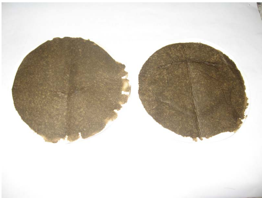
กระดาษกรองที่ผ่านการทดสอบที่ทางเข้า (ซ้าย) และที่ทางออก (ขวา) ในการทดสอบครั้งที่ 7
