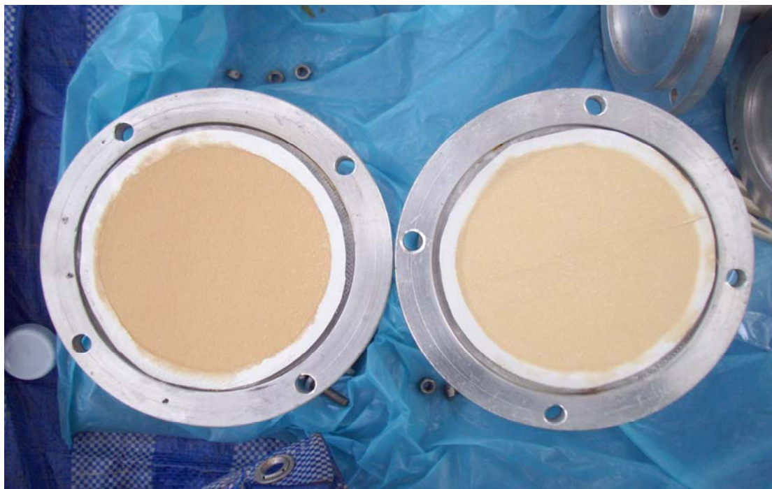
กระดวยกรองที่ผ่านการทดสอบที่ทางเข้า (ซ้าย) และที่ทางออก (ขวา) ในการทดสอบครั้งที่ 9
