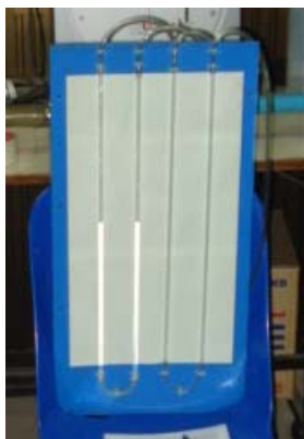
รูปที่ 3.10 หลอดแก้วทำมานอมิเตอร์
