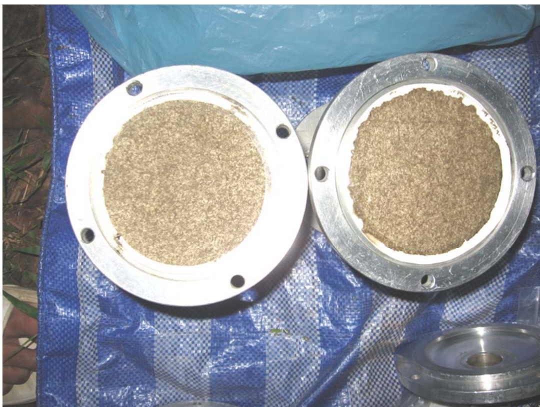
กระดวยกรองที่ผ่านการทดสอบที่ทางเข้า (ซ้าย) และที่ทางออก (ขวา) ในการทดสอบครั้งที่ 9
