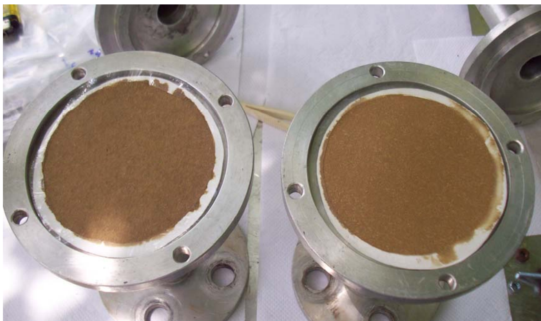
กระดวยกรองที่ผ่านการทดสอบที่ทางเข้า (ซ้าย) และที่ทางออก (ขวา) ในการทดสอบครั้งที่ 4
