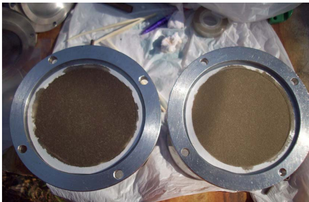
กระดวยกรองที่ผ่านการทดสอบที่ทางเข้า (ซ้าย) และที่ทางออก (ขวา) ในการทดสอบครั้งที่ 7
