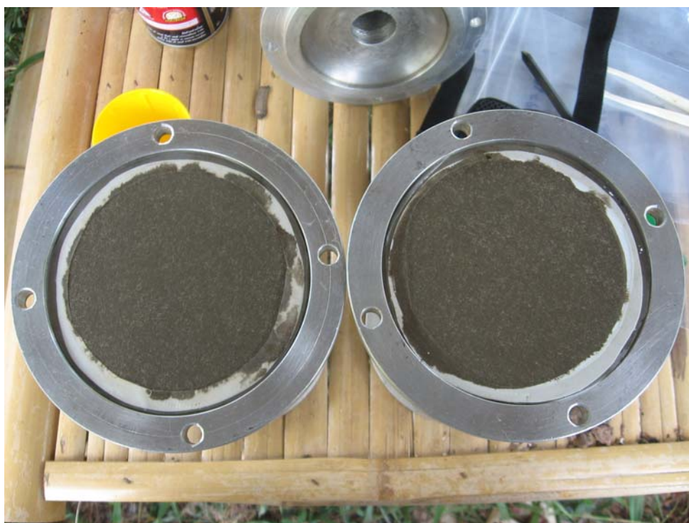
กระดวยกรองที่ผ่านการทดสอบที่ทางเข้า (ซ้าย) และที่ทางออก (ขวา) ในการทดสอบครั้งที่ 6
