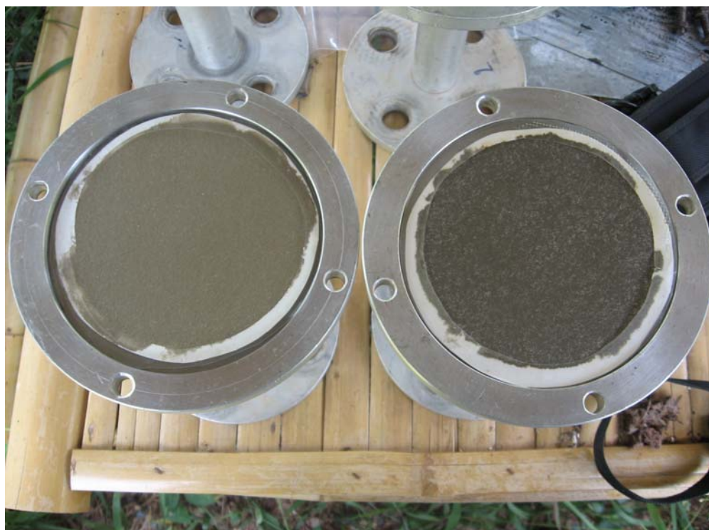
กระดวยกรองที่ผ่านการทดสอบที่ทางเข้า (ซ้าย) และที่ทางออก (ขวา) ในการทดสอบครั้งที่ 2
