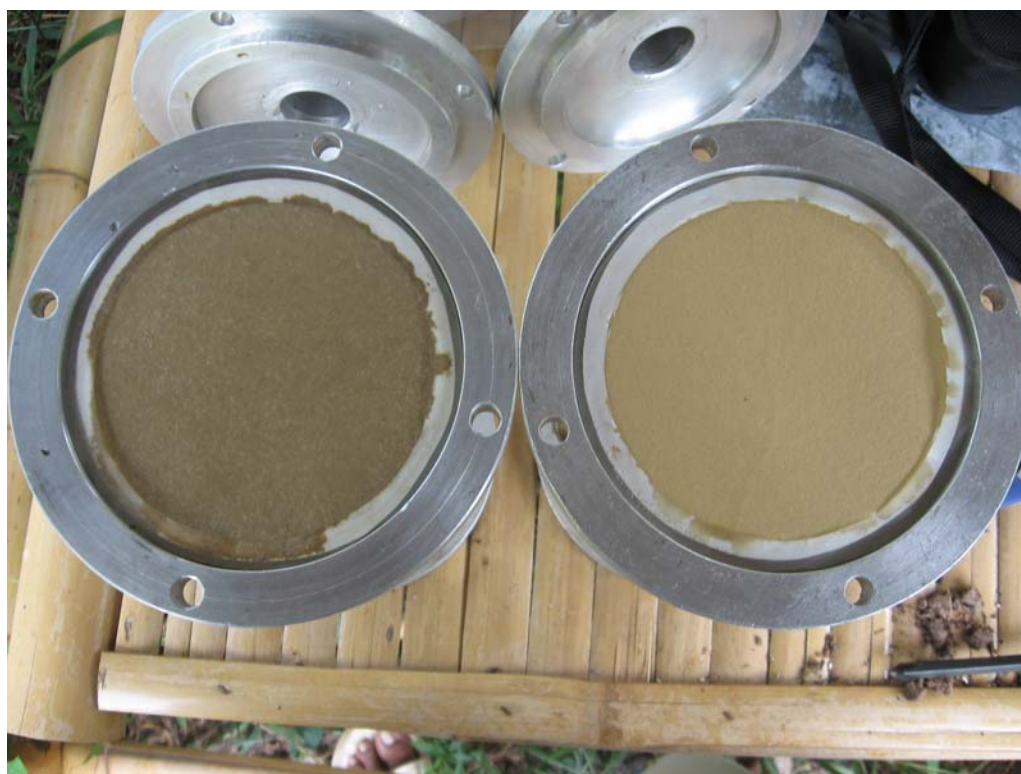
กระดาษกรองที่ผ่านการทดสอบที่ทางเข้า (ซ้าย) และที่ทางออก (ขวา) ในการทดสอบครั้งที่ 1
