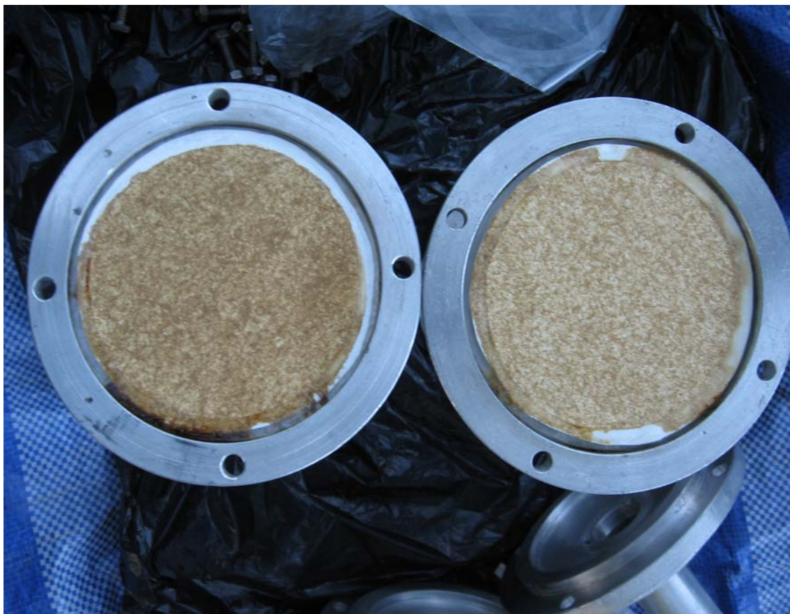
กระดาษกรองที่ผ่านการทดสอบที่ทางเข้า (ซ้าย) และที่ทางออก (ขวา) ในการทดสอบครั้งที่ 2
