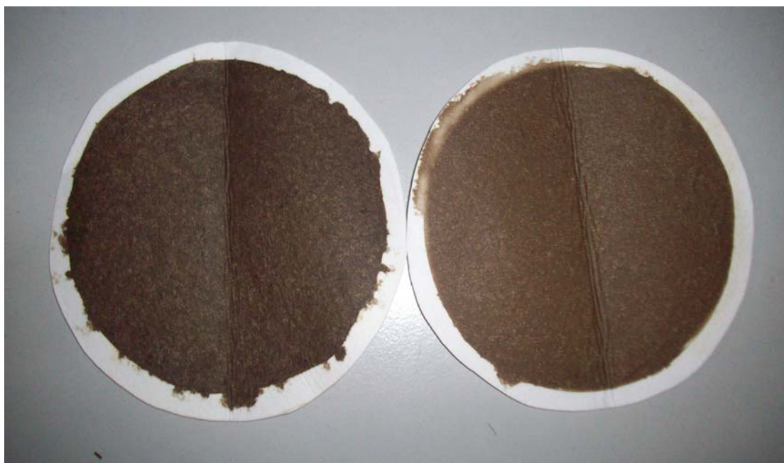
กระดวยกรองที่ผ่านการทดสอบที่ทางเข้า (ซ้าย) และที่ทางออก (ขวา) ในการทดสอบครั้งที่ 9
