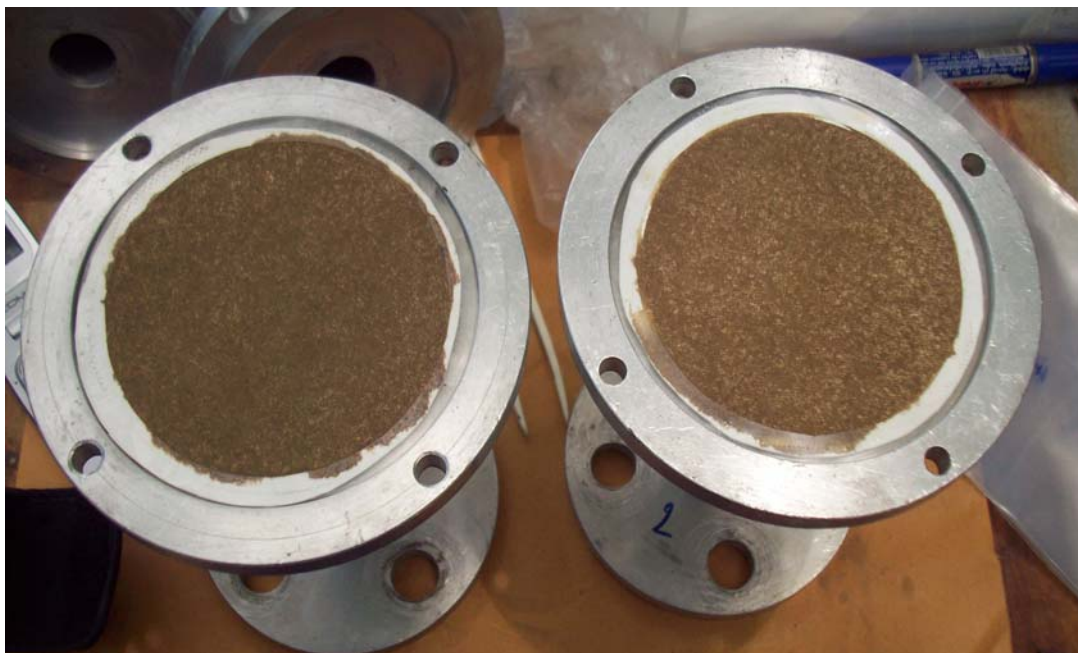
กระดวยกรองที่ผ่านการทดสอบที่ทางเข้า (ซ้าย) และที่ทางออก (ขวา) ในการทดสอบครั้งที่ 2
