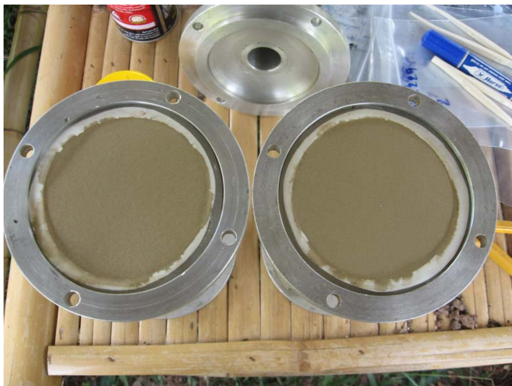
กระดวยกรองที่ผ่านการทดสอบที่ทางเข้า (ซ้าย) และที่ทางออก (ขวา) ในการทดสอบครั้งที่ 8
