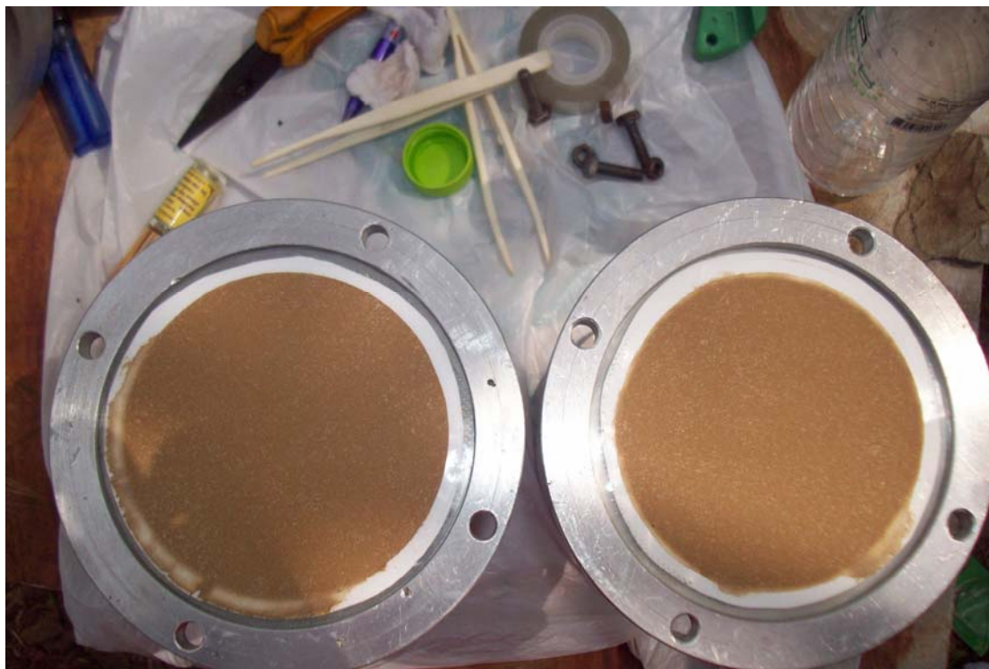
กระดวยกรองที่ผ่านการทดสอบที่ทางเข้า (ซ้าย) และที่ทางออก (ขวา) ในการทดสอบครั้งที่ 9
