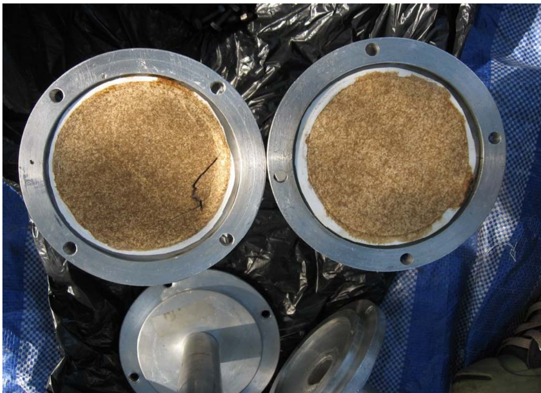
กระดวยกรองที่ผ่านการทดสอบที่ทางเข้า (ซ้าย) และที่ทางออก (ขวา) ในการทดสอบครั้งที่ 3
