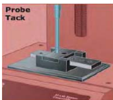
ภาพประกอบที่ 3 แสดงภาพ probe tack test (ตามมาตรฐาน ASTM D 2979-01, Volume : 15.06)
