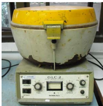
รูปที่ 3.10 เครื่องเซนตริฟิวจ์ ยี่ห้อ SORVAL รุ่น GLC-2
