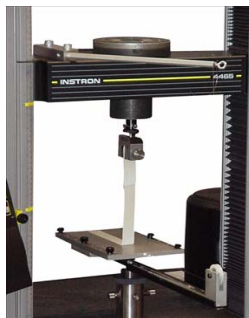
ภาพประกอบที่ 5 การทดสอบการดึงลอกออกในแนว 90 องศา (มาตรฐาน ASTM D6252/D6252 M-98 2004, Volume : 15.09)
