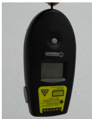
รูปที่ 3.4 เครื่องวัดอุณหภูมิอินฟราเรด (IR thermometer)
