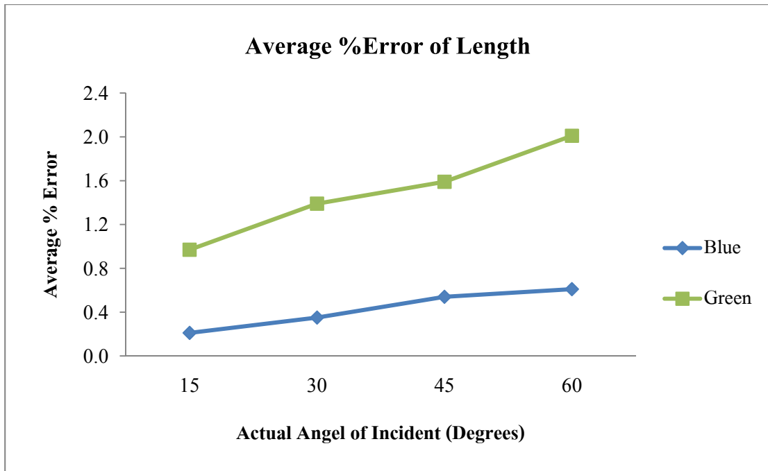
ภาพประกอบที่ 3.3 แสดงผลการหาค่าเฉลี่ยเปอร์เซ็นต์ความผิดพลาดของ marker สีน้ำเงิน และสีเขียวของความยาวของรอยคราบเลือด
