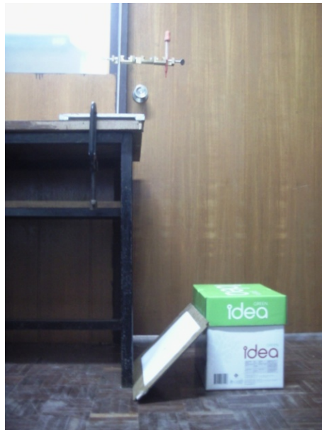
ภาพประกอบที่ 2.34 แสดงสร้างรอยคราบเลี้ยวที่มุมตกกระทบต่างๆ โดยใช้หลอดหยด
