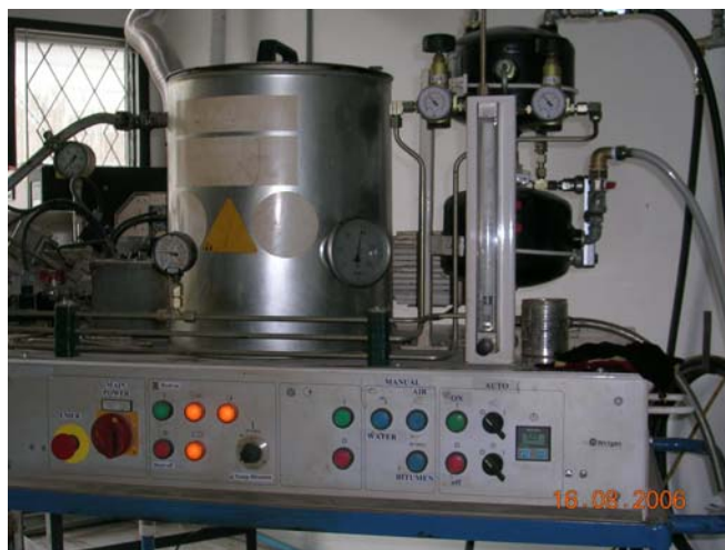
รูปที่ 3.6 เครื่องมือที่ใช้ในการผลิต โฟมเอสฟลด์ ของสำนักวิจัยและพัฒนาทาง
