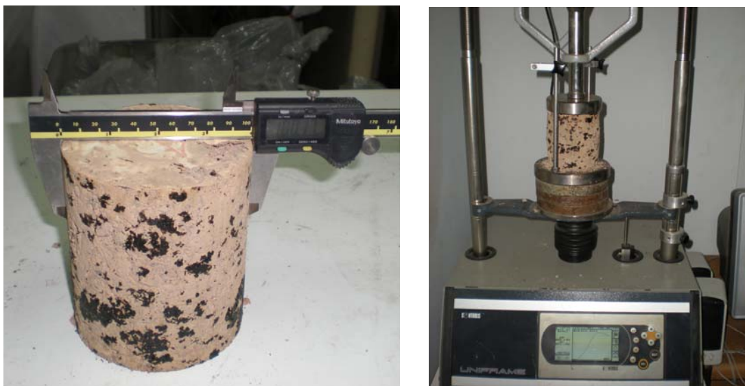
รูปที่ 3.18 ก้อนตัวอย่างใช้ในการทดสอบค่ากำลังรับแรงอัด
