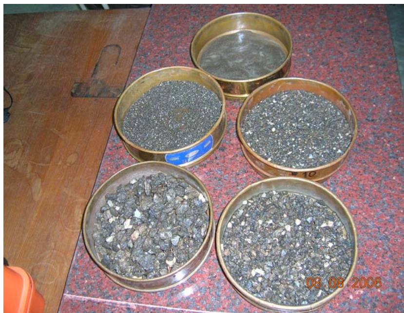
รูปที่ 3.4 การทดลองหาขนาดเม็ดวัสดุ โดยผ่านตะแกรงแบบล้าง
