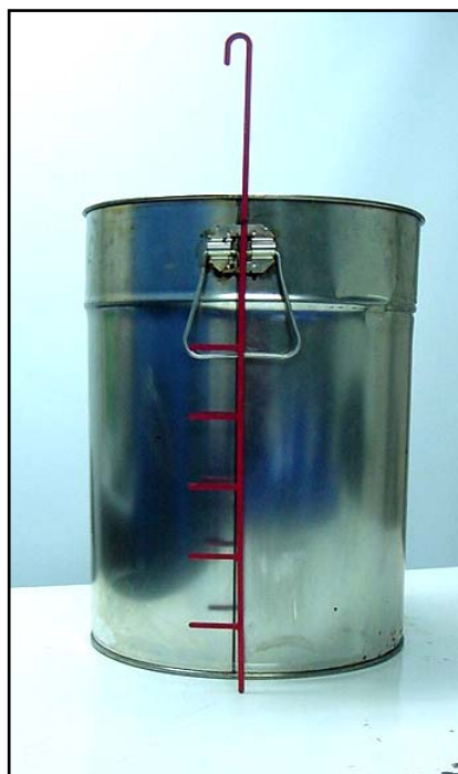
รูปที่ 3.7 อุปกรณ์ที่ใช้วัดค่าในการผลิต โฟมเอสฟลด์
