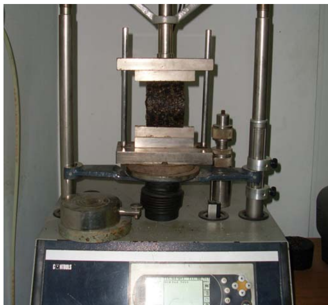
รูปที่ 3.14 การทดสอบค่าแรงดึงทางอ้อม
