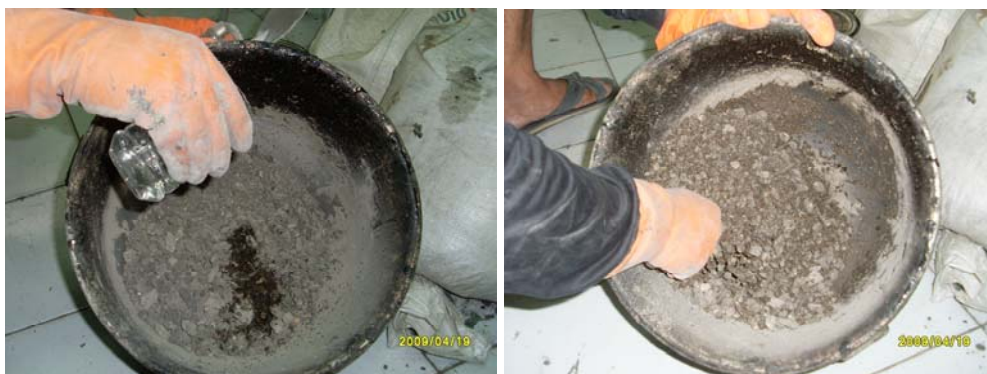
รูปที่ 3.9 ขั้นตอนการผสมน้ำเข้ากับวัสดุรวม
