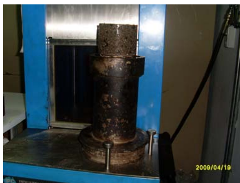
รูปที่ 3.11 ขั้นตอนการนำวัสดุรวมบดอัดด้วยเครื่อง Gyrotory Compaction
