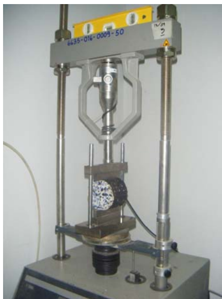
รูปที่ 3.17 การติดตั้งก้อนตัวอย่างในการทดสอบความต้านทานแรงดึงทางอ้อม
