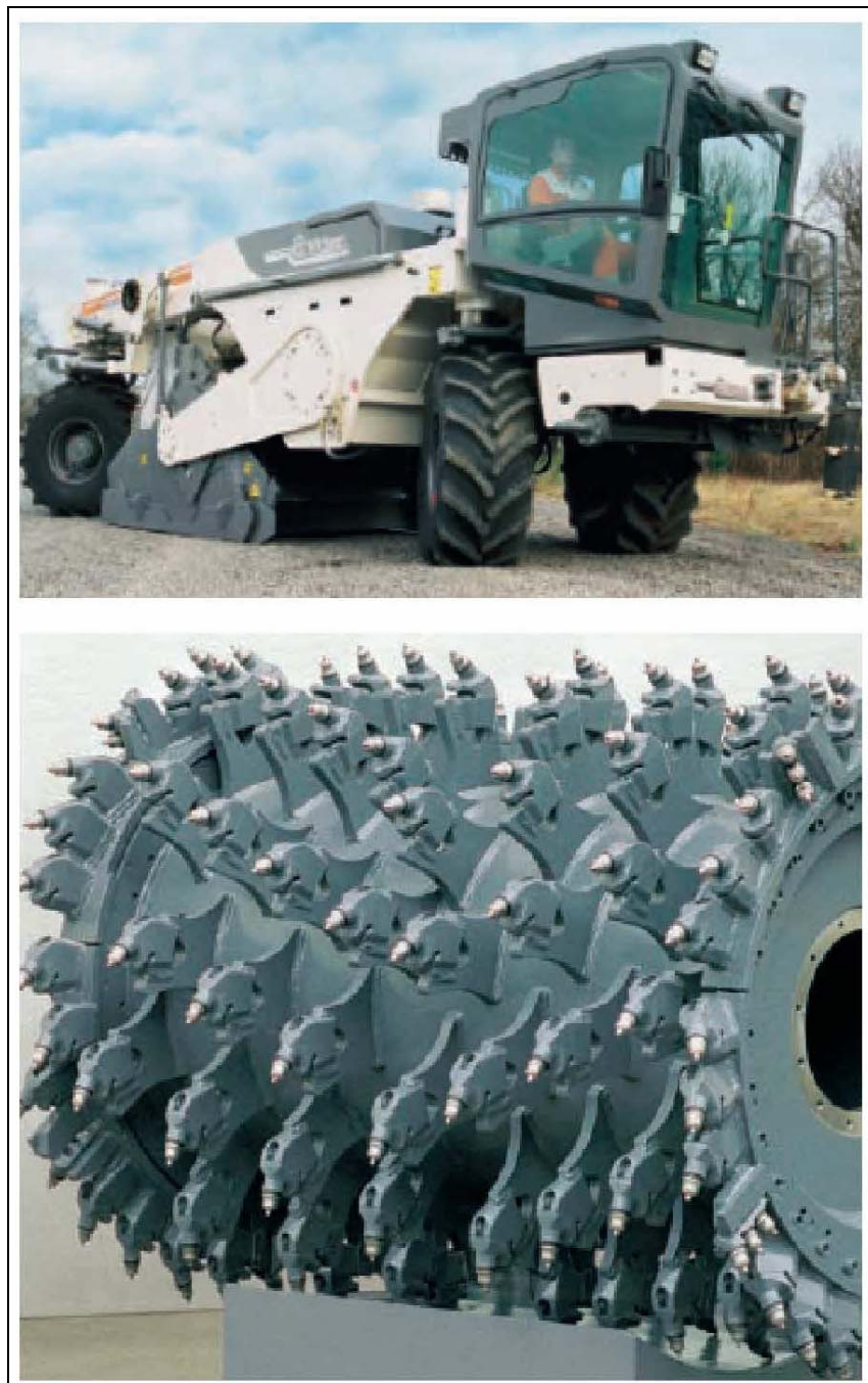
รูปที่ 2.5 เครื่องจักรที่ใช้ในงานปรับปรุงวัสดุโครงสร้างทางเดิมโดยวิธีผสมเย็นในที่ ที่มา : Pavement Recycling Guidelines for State and Local Governments, Prithvi et. al., 1997
