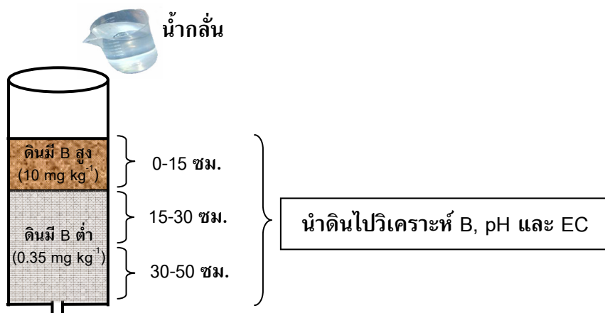
รูปที่ 2 วิธีการชะล้างโบรอนในดินด้วยน้ำกลั่น
