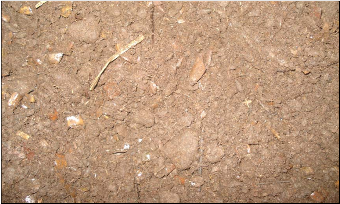
รูปที่ ข.19 ผลิตภัณฑ์ในวันที่ 60 ของถ้ำหมักที่ 4 (ของเสียโรงงานผลิตยางแท่ง+มูลวัว+ผักตบชวา)
