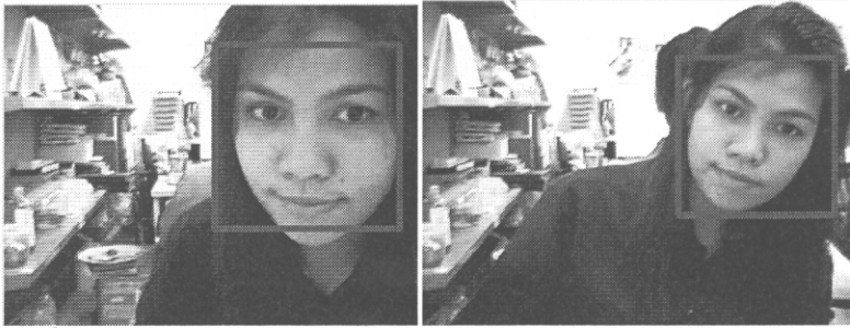
รูปที่ 3.2: ผลลัพธ์จากการรวมวิธีการของ Harr-like และ Camshift
