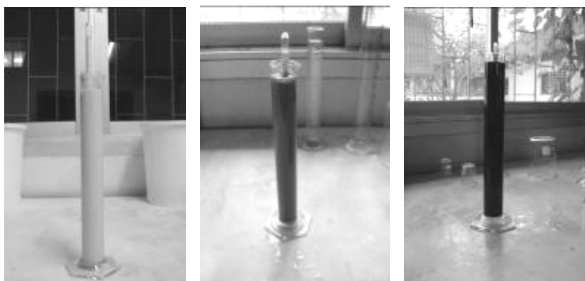
ภาพประกอบที่ จ-5 การวัดค่าความถ่วงจำเพาะของสเลอรีที่เตรียมจาก ดินขาว จีเถ้าไม้ยางพารา และจีเถ้าไยปาล์ม ตามลำดับ
