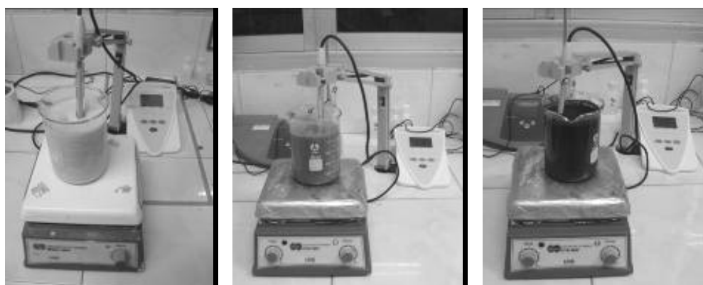
ภาพประกอบที่ จ-6 การวัดค่าพีเอชของสเลอรีที่เตรียมจาก ดินขาว จีเถ้าไม้ยางพารา และจีเถ้าไยปาล์ม ตามลำดับ
