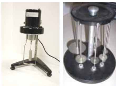
ภาพประกอบที่ จ-1 เครื่องวัดความหนืดชนิด Brookfield viscometer
