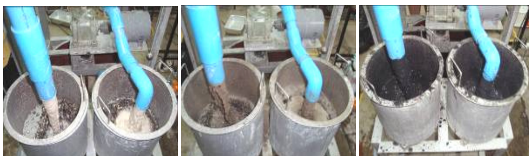
ภาพประกอบที่ จ-8 การแยกเมล็ดดินและกะลาปาล์มโดยการทดลองระดับ pilot scale โดยใช้ดินขาว จีเถ้าไม้ยางพารา และจีเถ้าไยปาล์ม ตามลำดับ
