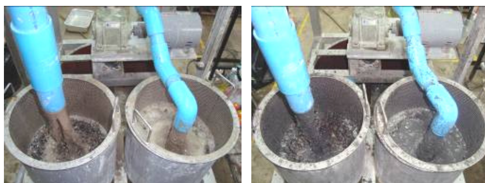
ภาพประกอบที่ จ-9 การแยกเมล็ดดินและกะลาปาล์มโดยการทดลองระดับ pilot scale โดยใช้ดินขาวผสมจีเถ้าไม้ยางพารา และดินขาวผสมจีเถ้าไยปาล์ม ตามลำดับ
