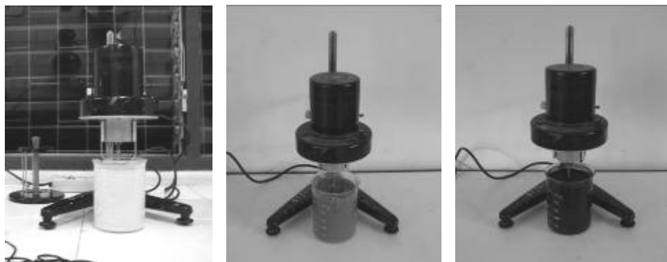
ภาพประกอบที่ จ-7 การวัดค่าความหนืดของสเลอรีที่เตรียมจาก ดินขาว จีเถ้าไม้ยางพารา และจีเถ้าไยปาล์ม ตามลำดับ
