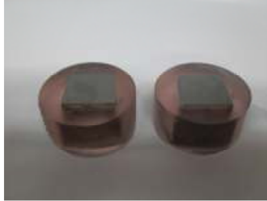
รูปที่ 3.4 แสดงลักษณะรูปร่างของชิ้นงานที่นำไปทำการตรวจสอบโครงสร้างจุลภาค
