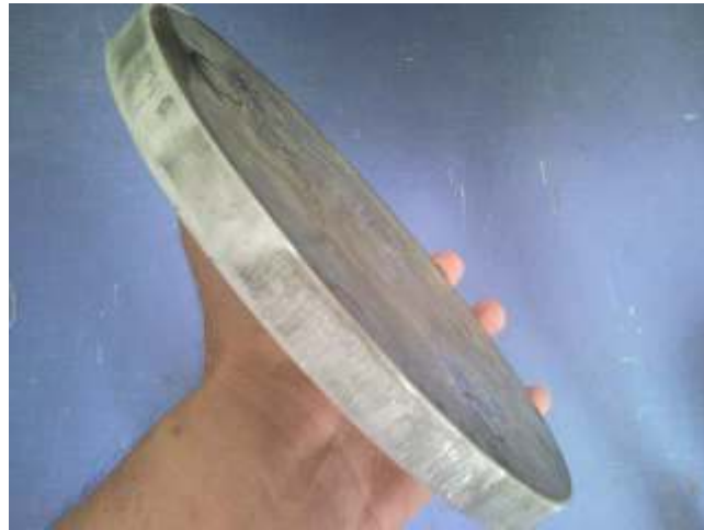
รูปที่ 3.2 ชิ้นงานหล่อที่ได้จากการขึ้นรูปโลหะกึ่งของแข็ง โดยวิธี Squeeze cast เกรด A356
