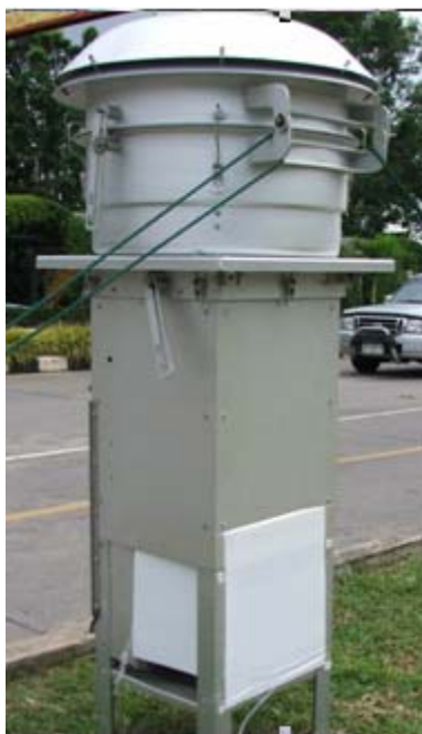
รูปที่ 2-2 เครื่อง High volume air sampler (Graseby Anderson รุ่น IP1070BL ACCU_Vol System)
