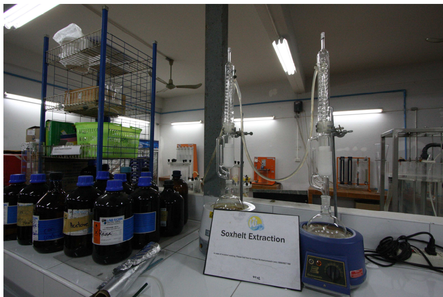
รูปที่ 3.9 เครื่องมือล้างเรซิน Soxhelt extraction
