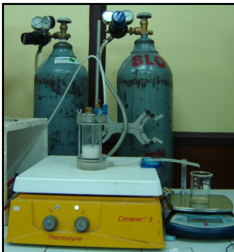
ภาพประกอบที่ 4.2 การแยกด้วยเมมเบรนในชุดกรองขนาดความจุ 150 มิลลิลิตร
