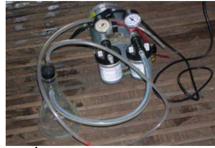
ภาพที่ 18 อุปกรณ์เก็บของเหลวจาก- กระเพาะรูเมน
