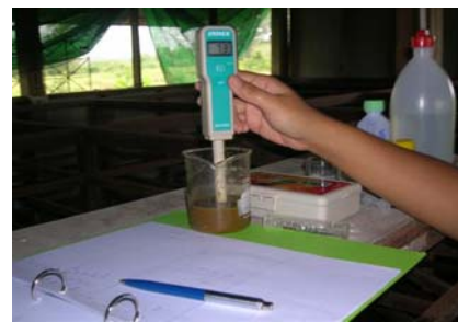
ภาพที่ 20 การวัดค่าความเป็นกรด-ด่าง ของของเหลวจากกระเพาะ- รูเมน
