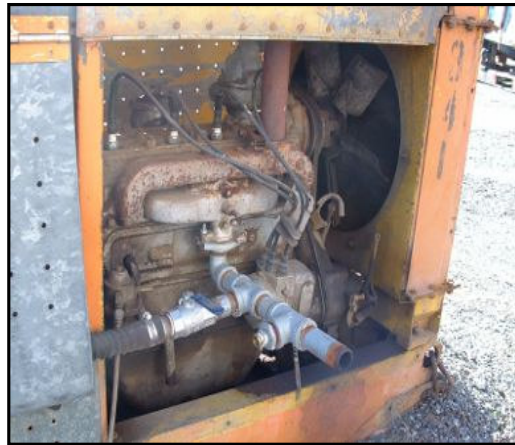
Figure 5. A modified gasoline engine operated by biogas ที่มา : ปฏิกรณ์ แสนสิ่ง, 2548
