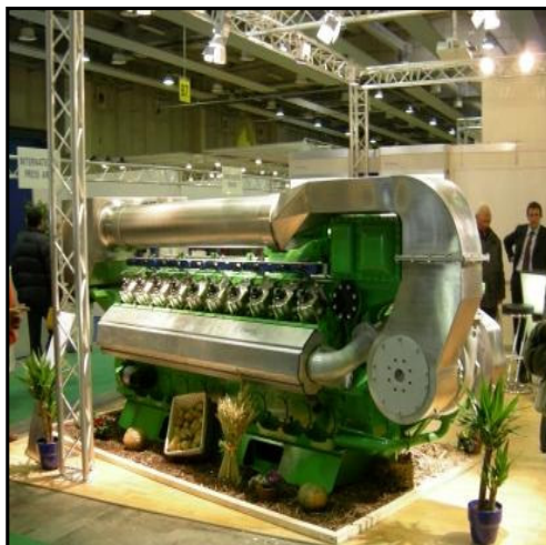
Figure 7. A generator with a capacity 500-1,000 kW operated by biogas ที่มา : ปฏิกรณ์ แสนสิ่ง, 2548
