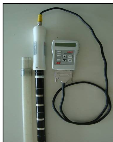
ภาคผนวกภาพที่ 6 เครื่องมือวัดความชื้นดิน (Soil Profile Probe : Moisture Meter type HH2, Delta-T Devices Ltd, Cambridge, U.K.)
