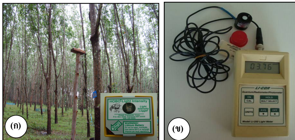
ภาคผนวกภาพที่ 7 เครื่องมือวัดปริมาณความเข้มแสง (ก) HOBOLight intensity: Onset Computer Corporation, USA (ข) Light Meter (1 sensor): LI-COR, Quantum/Radiometer/Photometer
