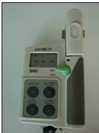
ภาคผนวกที่ 10 เครื่องมือวัดปริมาณไนโตรเจนและคลอโรฟิลล์ (Chlorophyll Meter, SPAD-502)
