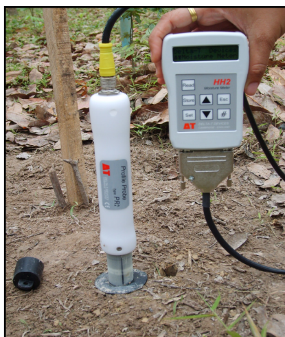
ภาคผนวกภาพที่ 6 เครื่องมือวัดความชื้นดิน (Soil Profile Probe : Moisture Meter type HH2, Delta-T Devices Ltd, Cambridge, U.K.)
