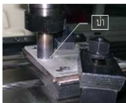
(ก) บ่าของ Tool ห่างจากขอบชิ้นงาน 10 มม. (ข) แรงกดเริ่มต้น 450 กก. ก่อนเดินแนวเชื่อม 28 วินาที
