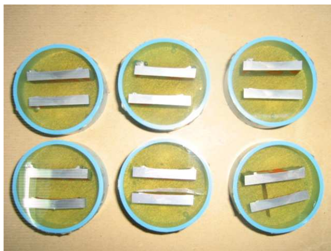
รูปที่ 3.16 แสดงชิ้นงานที่เคลือบด้วยน้ำยา Epoxy
