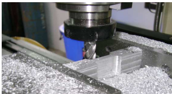
รูปที่ 3.24 ภาพแสดงการขึ้นรูปชิ้นทดสอบแรงดึงของเนื้อโลหะเดิม
