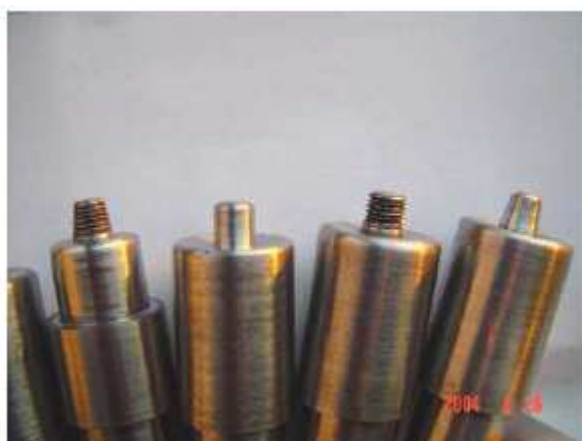
รูปที่ 2.11 แสดงลักษณะของหัวพินที่ใช้ในการเชื่อมเสียดทานแบบกวน
