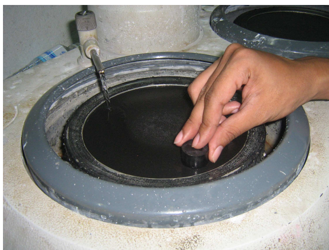
รูปที่ 3.17 แสดงการเตรียมชิ้นงานเพื่อตรวจสอบ โครงสร้างทางโลหะวิทยา
