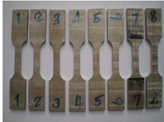
รูปที่ 3.25 ภาพแสดงชิ้นทดสอบมาตรฐานของเนื้อโลหะเดิม SSM A356
