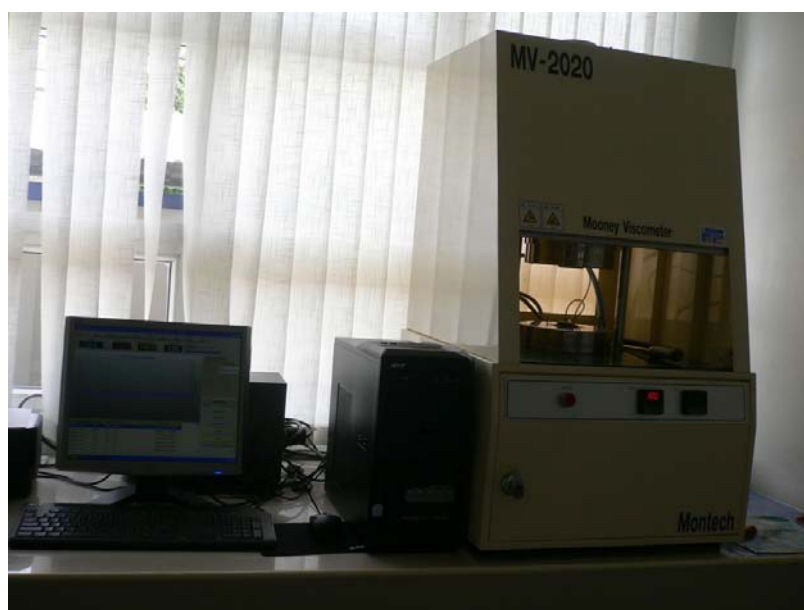
ภาพประกอบที่ 3.5 เครื่องมูนนี่วิต โคมิเตอร์ (Mooney Viscosity)
