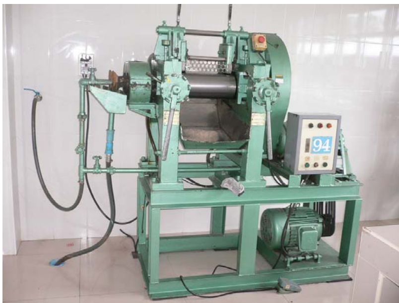
ภาพประกอบที่ 3.4 เครื่องผสมสองลูกกลิ้ง (Two Rolls Mill)
