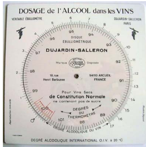
ภาพที่ ก-1 แผ่นสเกลสำหรับอ่านค่าอุณหภูมิและเปอร์เซ็นต์แอลกอฮอล์ ที่มา : http://www.dujardin-salleron.net
