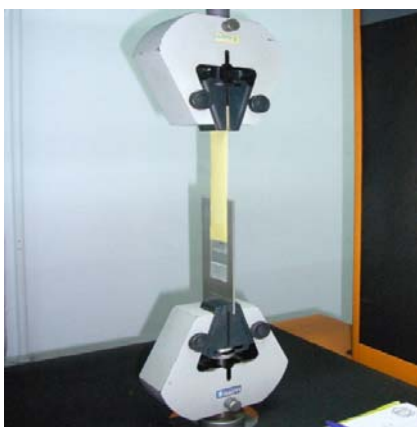
รูปที่ 3.13 เครื่องทดสอบการดึงลอกแบบ 180° peel (LLOYD Tensile tester)
