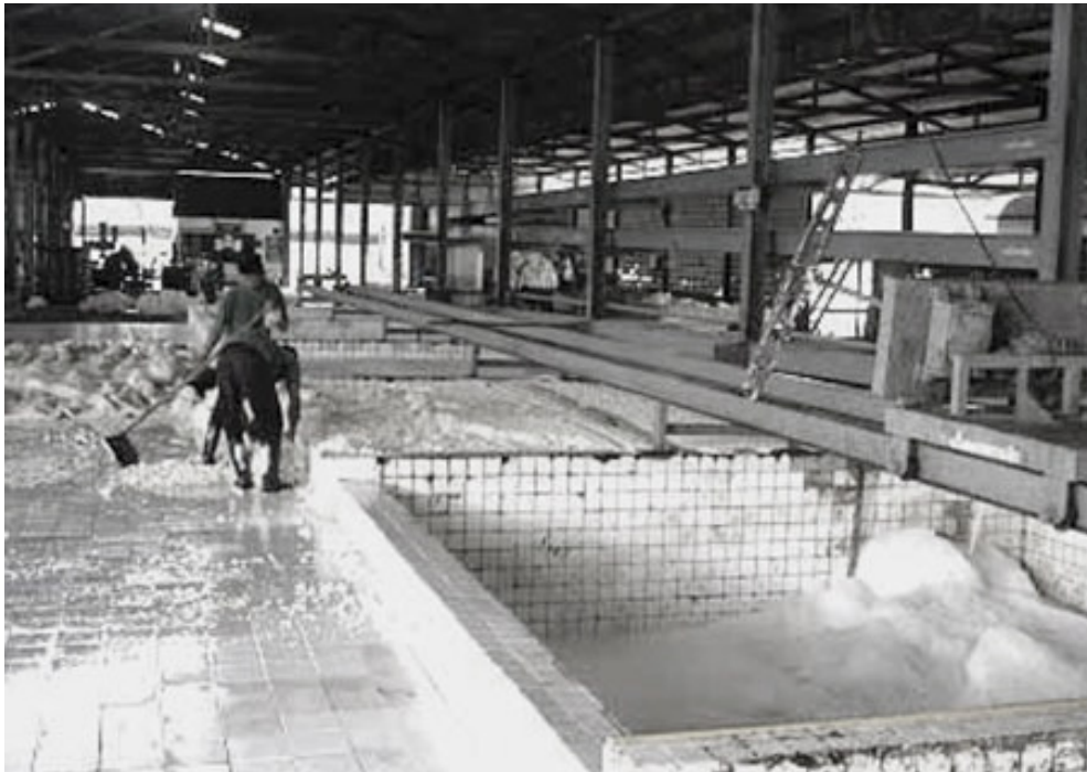
รูปที่ 2.12 ภาพแสดงการจับตัวในกระบวนการรวบรวมและการจับตัวเนื้อยางสกิมในโรงงานอุตสาหกรรมน้ำยาง
