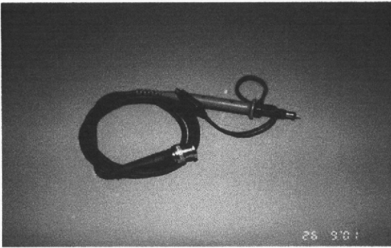
ภาพประกอบที่ 29 แสดงรูปตัวลดทอนแรงดันขนาด 10 ต่อ 1
