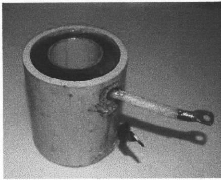
ภาพประกอบที่ 33 แสดงรูปตัวเก็บประจุที่ทำจากสายโคเอกเซียล
