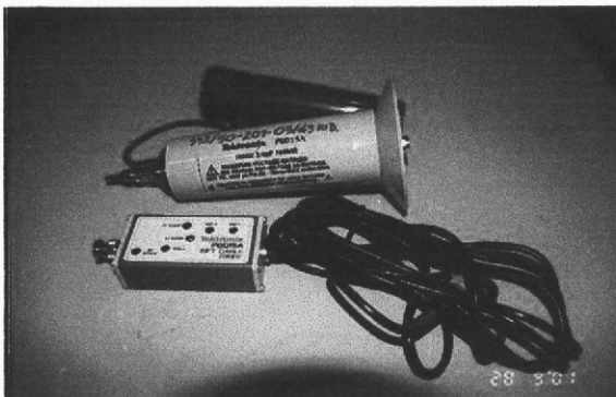
ภาพประกอบที่ 30 แสดงรูปหัววัดลดทอนแรงดัน 1000 ต่อ 1
