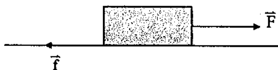
รูปที่ 21 แรง \vec{F} และ \vec{f} กระทำต่อวัตถุ
