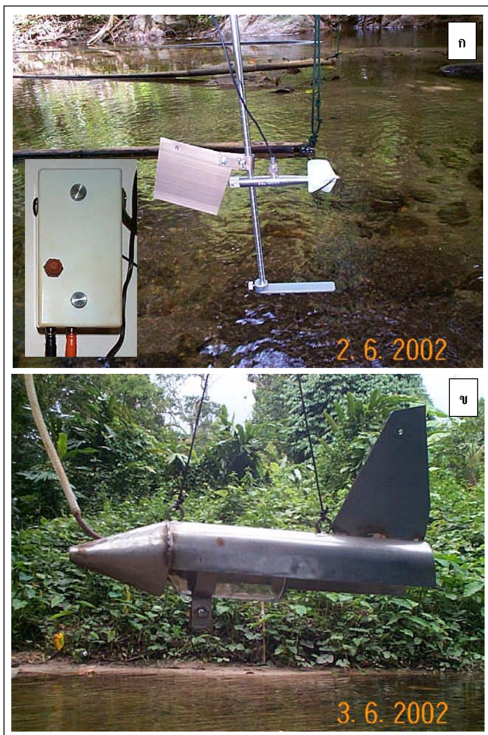
รูปภาคผนวกที่ 1 เครื่องวัดกระแสน้ำ (current meter) แบบใบพัด (propeller type) (ก) และ เครื่องเก็บตัวอย่างน้ำแบบ Depth-integratig sample (ข)
