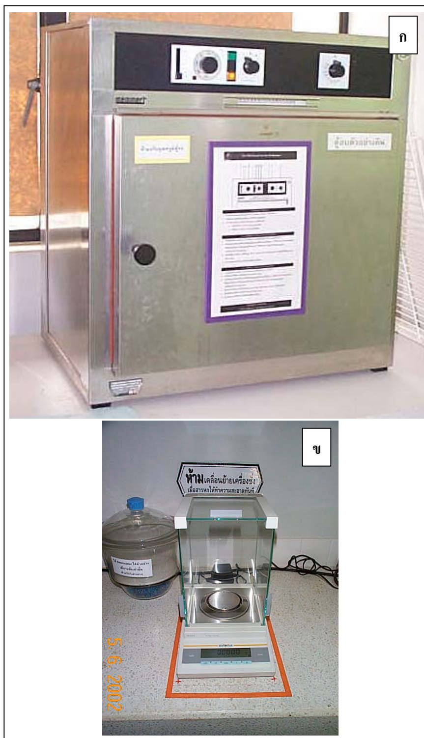
รูปภาคผนวกที่ 7 ตู้อบความร้อน (ก) และเครื่องชั่งแบบละเอียด 4 ตำแหน่ง (ข)
