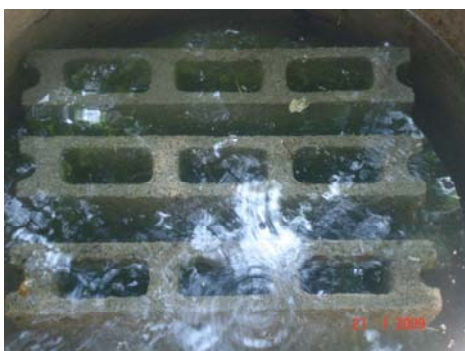
รูปที่ 3.10 การบ่มตัวอย่างอิฐบล็อก ขนาด 7 \times 19 \times 39 ลูกบาศก์เซนติเมตร
