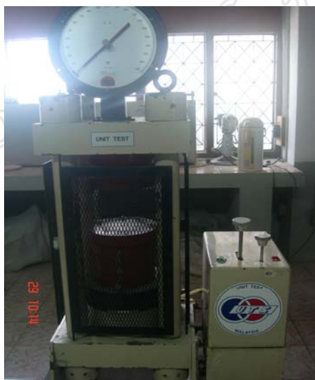
รูปที่ 3.6 เครื่องทดสอบความต้านการอัดของคอนกรีต
