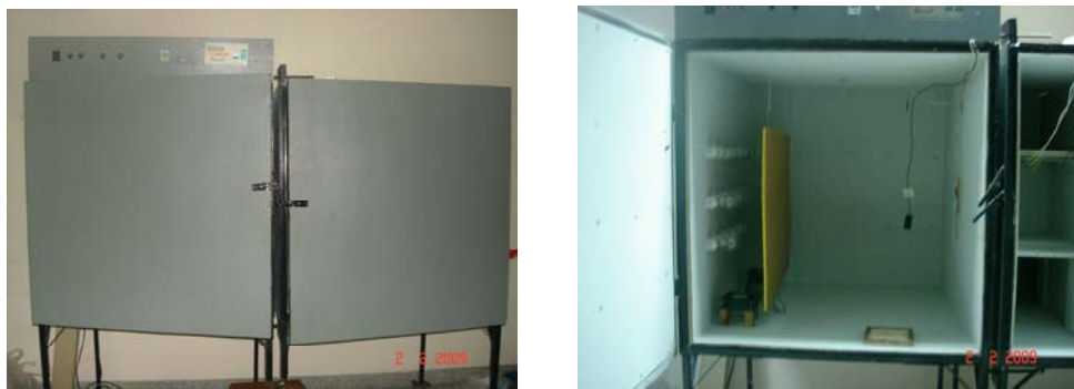
รูปที่ 3.9 ชุดทดสอบสมบัติเชิงความร้อนของวัสดุ
