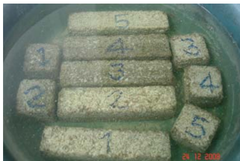
รูปที่ 3.11 การบ่มตัวอย่างอิฐบล็อก ขนาด 5 \times 5 \times 5 และ 4 \times 4 \times 16 ลูกบาศก์เซนติเมตร
