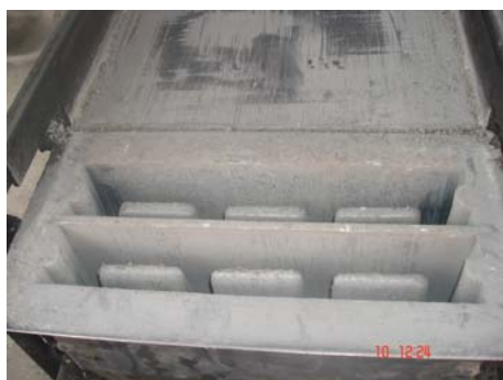
รูปที่ 3.4 เบ้าหล่ออิฐบดลือก ขนาด 7×19×39 ลูกบาศก์เซนติเมตร
