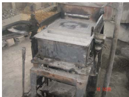
รูปที่ 3.3 เครื่องอัดบดลือกคอนกรีต
