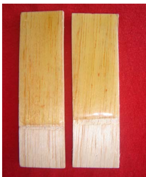
รูปที่ 4.14 ตัวอย่างสารเคลือบผิวบนวัสดุไม้ที่ได้สูตรที่ดีที่สุดจากการใช้ TPGDA : Irgacure 651 = 80 : 10 (phr) โดยผ่านการฉายแสง อัลตราไวโอเล็ตเวลา 90 วินาที
