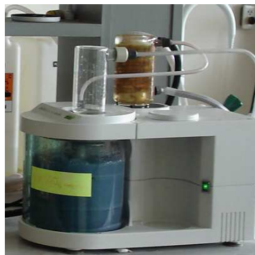
ภาพประกอบที่ 3.11 เครื่องจับกรด BUCHI Distillation Model B - 324
