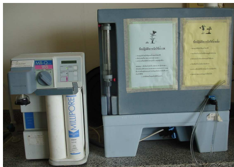
ภาพประกอบที่ 3.6 เครื่องผลิตน้ำปราศจากไอออน
