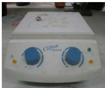
รูปภาพผนวกที่ ข8 เครื่องให้ความร้อน (Hot plate)
