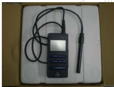
รูปภาพผนวกที่ ข4 เครื่องวัด ค่าการนำไฟฟ้า (Conductrometer)
