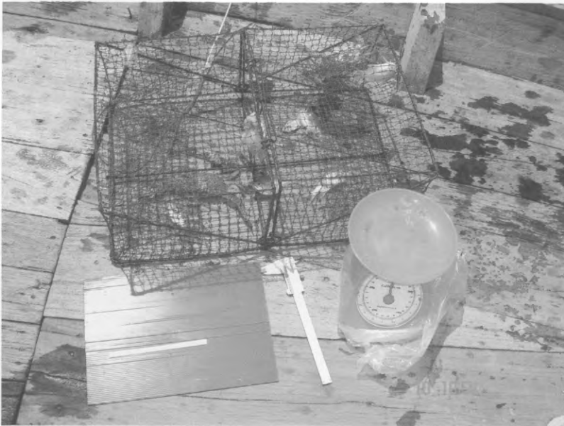
ภาพที่ 6 อุปกรณ์ที่ใช้ในการวัดการเจริญเติบโตของปูม้า ประกอบด้วยลอบปู เครื่องชั่ง และเวอร์เนีย
