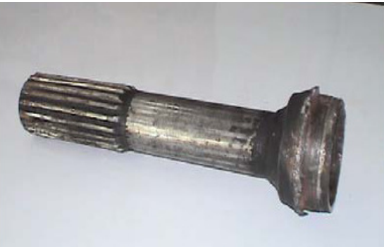
ชิ้นส่วน Spline ที่เชื่อมต่อระหว่างเฟืองท้ายกับเพลากลางหลุดอยู่บนถนน
