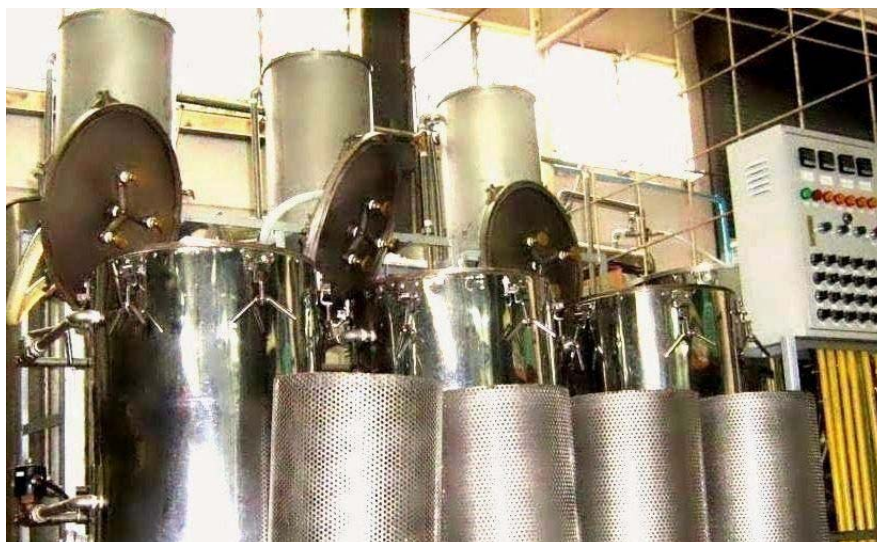
ภาพประกอบ 3-2 ส่วนสกัดของชุดสกัดแบบต่อเนื่องขนาดโรงงานจำลอง
