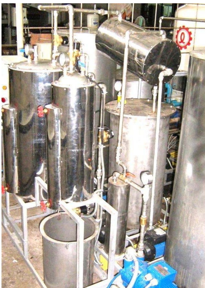
ภาพประกอบ 3-3 ส่วนระเหยของชุดสกัดแบบต่อเนื่องขนาดโรงงานจำลอง
