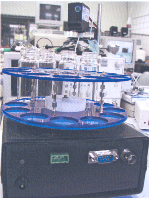
ภาพประกอบที่ 3-7 เครื่องเก็บตัวอย่างแยกส่วนอัตโนมัติ (ด้านหลัง)
