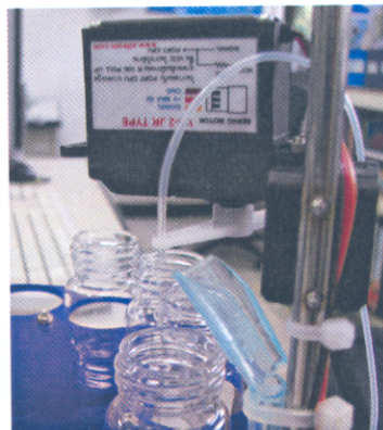
ภาพประกอบที่ 3-5 Servo motor ควบคุมทิศทางของการเก็บตัวอย่าง
