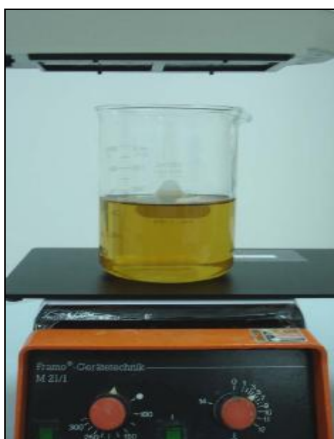
ภาพที่ 8 ชุดอุปกรณ์การทดลองเฟนตันรีเอเจนต์
