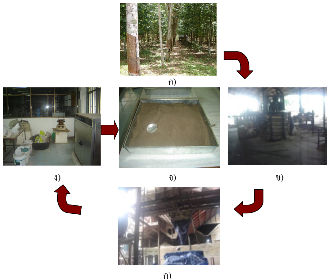
รูปที่ 3.3 ที่มาและการเตรียมเถาไม้ยางพารา ก) ต้นไม้ยางพารา ข) ท่อนไม้ยางพารา ค) เถาไม้ยางพารา จากปล่องควันไฟ ง) ผ่านตะแกรงเบอร์ 200 และ จ) เถาไม้ยางพาราที่ใช้ในการทดสอบ
