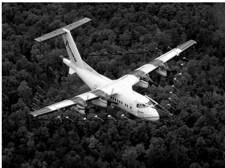
ภาพประกอบที่ 1.10 การบินสำรวจธรณีฟิสิกส์ทางอากาศด้วยเครื่องบินปีกแข็ง (ที่มา: http://www.cflhd.gov/igm/engApplications/SubsurfaceCharacter/614LocShallowSubgradeDeposits(2).htm [8 มีนาคม 2549])
