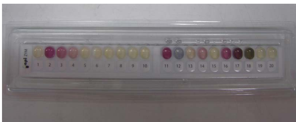
รูปที่ 8 การทดสอบการสร้างเอนไซม์ด้วยชุดทดสอบ (API ZYM test kit)
