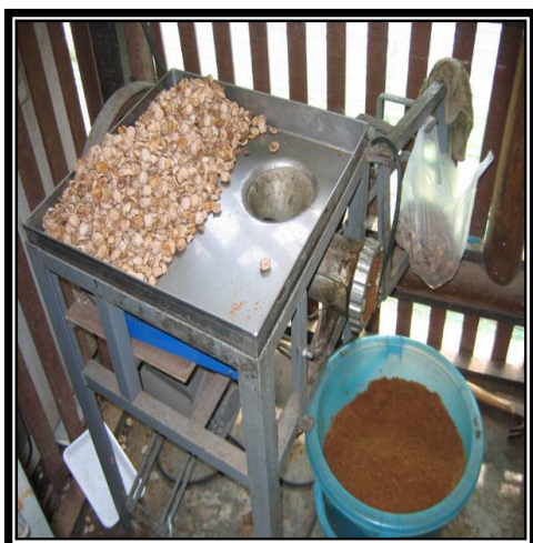
ภาพภาคผนวกที่ 5 เครื่องบดเนื้อในเมล็ด ยางพารา
