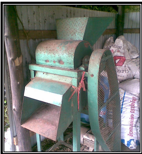
ภาพภาคผนวกที่ 1 เครื่องกะเทาะเมล็ดขางพารา
