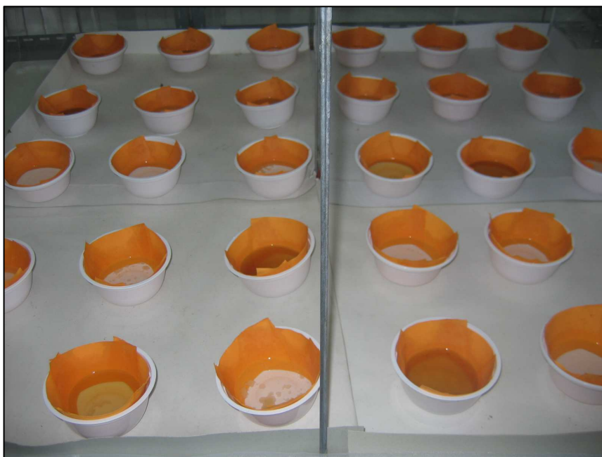
ภาพที่ 27 ลักษณะการวางชุดทดสอบแบบสุ่มในกรงทดสอบขนาด 120 x 120 x 60 เซนติเมตร
