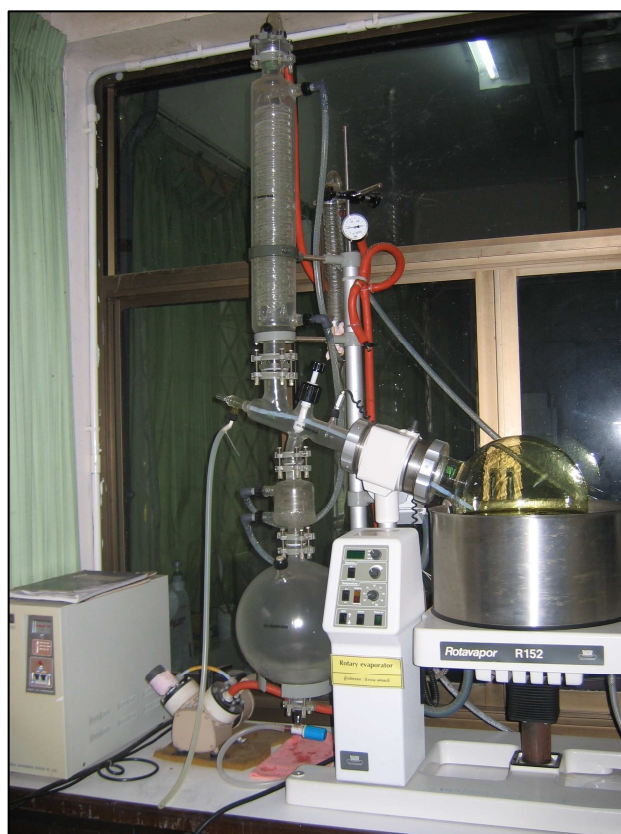
ภาพที่ 11 การสกัดสารโดยระเหยตัวทำละลายด้วยเครื่อง Rotary evaporator
