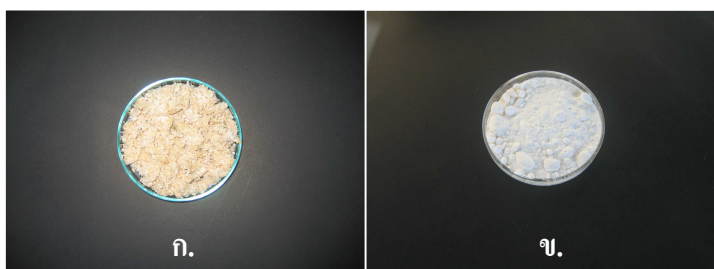
ภาพที่ 14 ส่วนผสมสำหรับเตรียมผลิตภัณฑ์แบบเม็ดกลมชนิดลอยน้ำประกอบด้วย กากมะพร้าวแห้ง (ก.) และ HVO (ข.)
