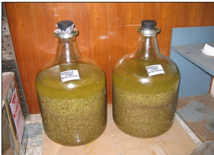
ภาพที่ 10 การแช่เนื้อในเมล็ดสะเดาซึ่งด้วยตัวทำละลายนอร์มอลเฮกเซนในขวดแก้วขนาด 20 ลิตร
