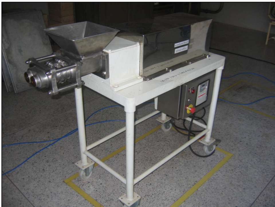
ภาพที่ 15 เครื่อง extruder สำหรับทำให้ส่วนผสมอัดกันแน่นและรีดออกมาเป็นเส้น
