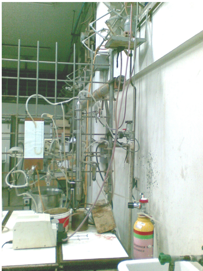
ภาพประกอบที่ 3-4 แสดงชุดการทดลองของคอลัมน์บรรจุที่ใช้ในห้องปฏิบัติการ
