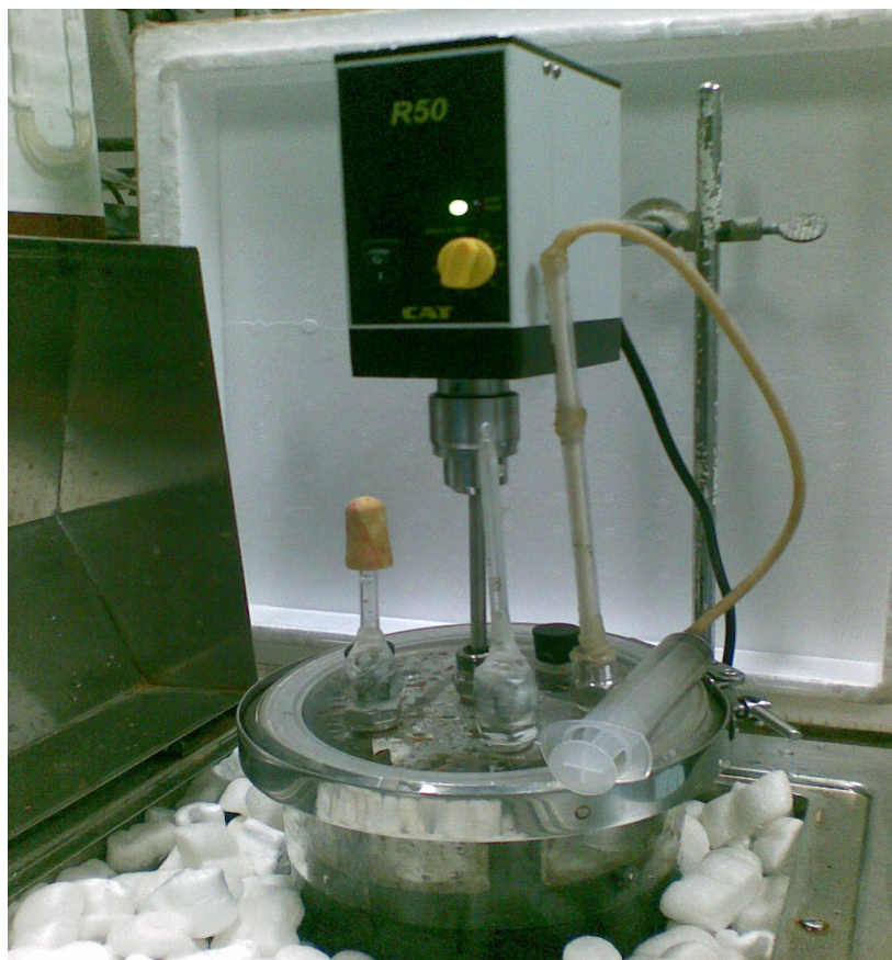
ภาพประกอบที่ 3-2 แสดงชุดอุปกรณ์การทดลองปฏิกิริยาแบบแบทซ์ในห้องปฏิบัติการ
