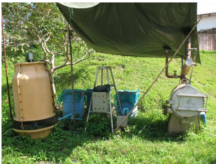
ภาพประกอบที่ 3.2 เตาเผาการผลิตน้ำส้มควันไม้ดิบ
