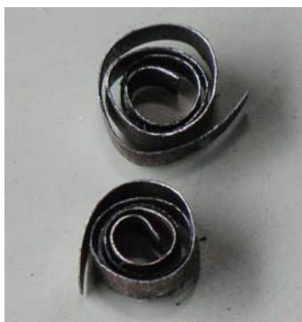
ภาพประกอบที่ 3.7 ลักษณะวัสดุบรรจุที่บรรจุในคอลัมน์ของเครื่องกลั่น
