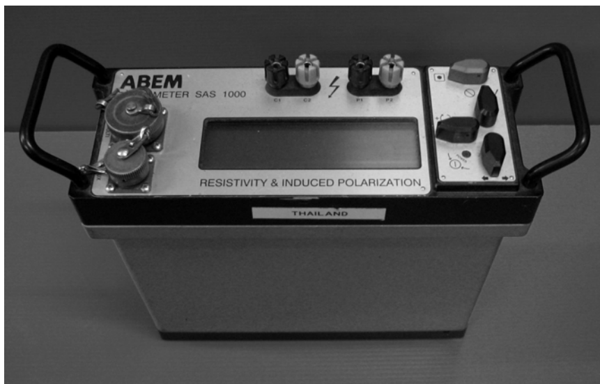
ภาพประกอบ 2.4 เครื่องวัดสภาพต้านทานไฟฟ้า ABEM TERRAMETER SAS 1000
