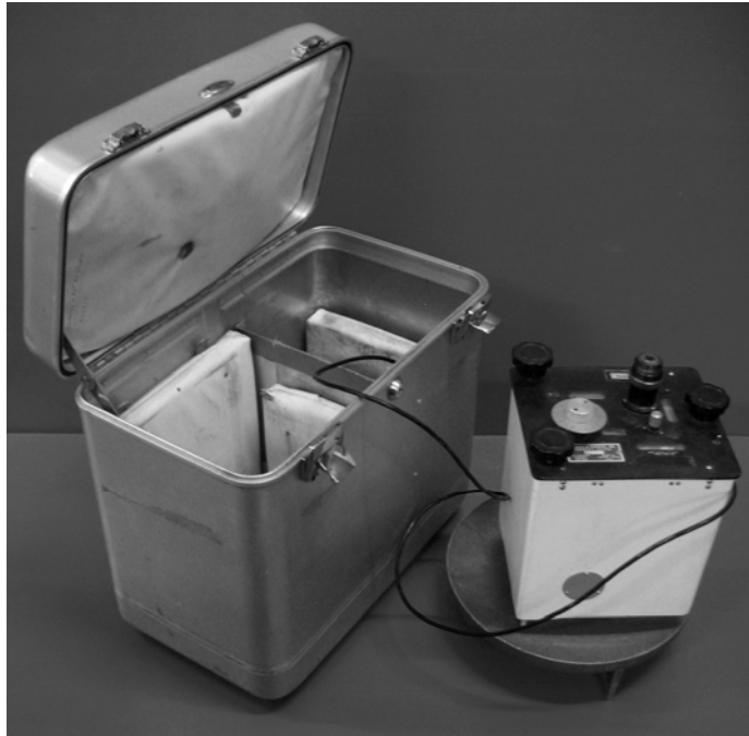
ภาพประกอบ 2.1 เครื่องแกรวิมิเตอร์ยี่ห้อลาคอสท์และรอมเบิร์ก
