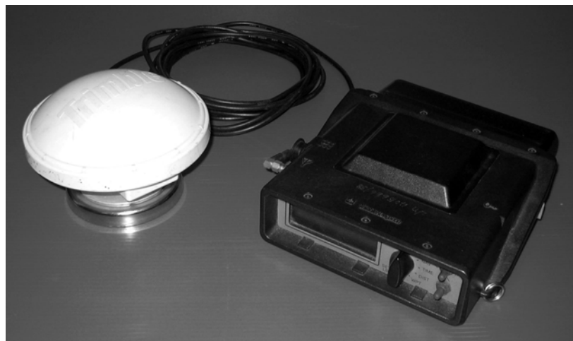
ภาพประกอบ 2.2 เครื่องอ่านพิกัด Trimble Pathfinder GPS.
