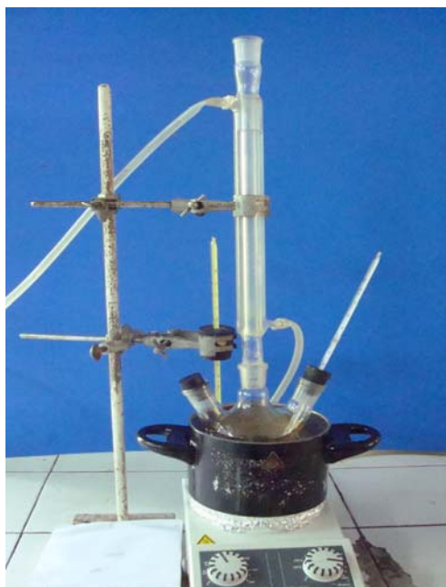
ภาพประกอบที่ 3.1 แสดงชุดการทดลองในการผลิตเมทิลเอสเทอร์แบบเบทซ์
