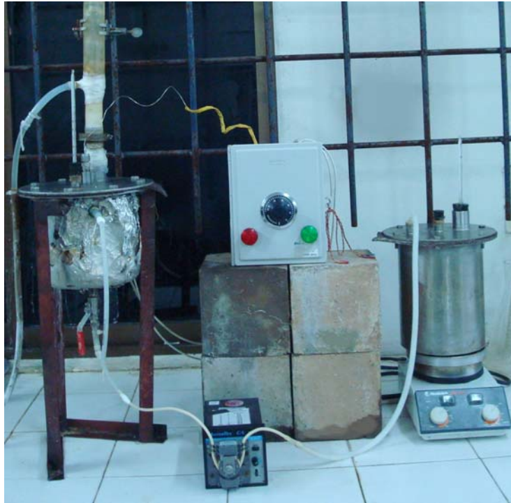
ภาพประกอบที่ 3.2 แสดงชุดการทดลองในการผลิตเมทิลเอสเทอร์แบบต่อเนื่อง
