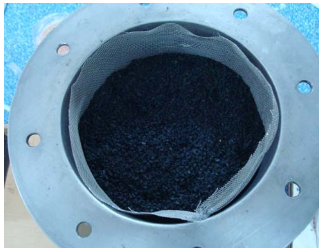
ภาพประกอบที่ 3.3 การบรรจุตัวเร่งปฏิกิริยาภายในถังปฏิกรณ์
