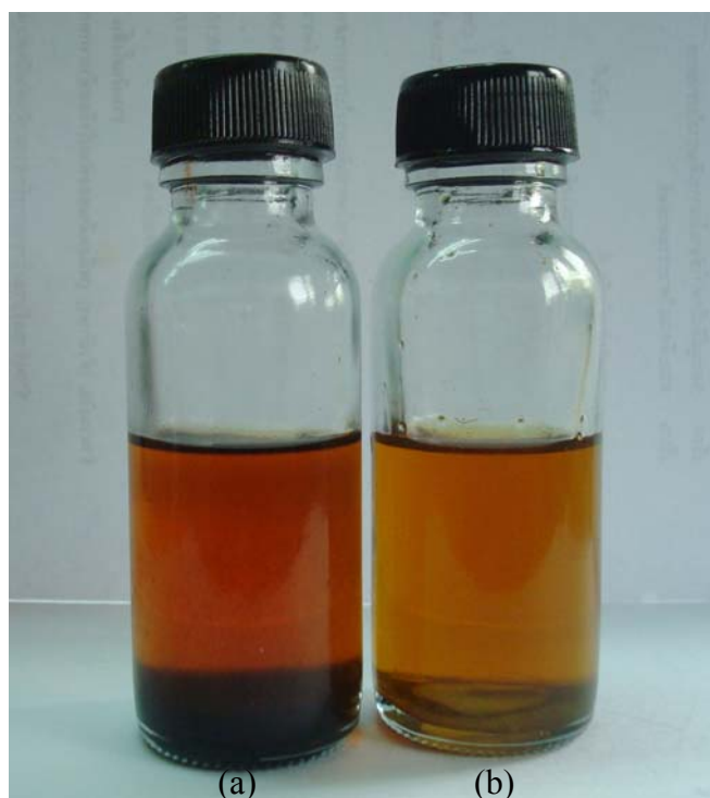
ภาพประกอบที่ 4.18 แสดงลักษณะของน้ำมันไบโอดีเซล : (a) น้ำมันไบโอดีเซลที่ผลิตจากกรดซัลฟิวริกบนผงถ่านกัมมันต์; (b) น้ำมันไบโอดีเซลที่ผลิตจากเฟอร์ริกซัลเฟตบนผงถ่านกัมมันต์
