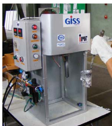
รูปที่ 3.3 แสดงการวัดอุณหภูมิของน้ำโลหะก่อนการจุ่มแท่งกราไฟต์เพื่อฟองแก๊สด้วยตัววัดอุณหภูมิ (Thermocouple)
