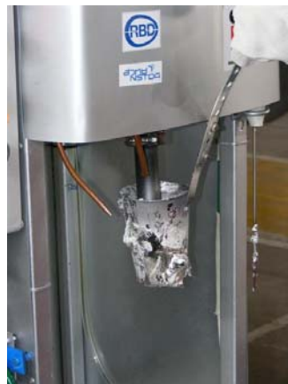
รูปที่ 3.4 แสดงการนำเข้าสู่เตาเผาที่ตักน้ำโลหะจากเตาหลอมมาจุ่มแท่งกราฟไฟต์และปล่อยฟองแก๊สเพื่อผลิตโลหะกึ่งของแข็งตามปริมาณสัดส่วนของแข็งที่ต้องการ
