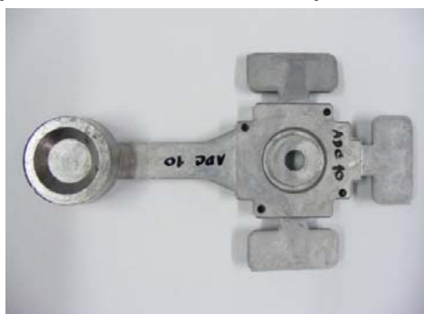
รูปที่ 3.29 แสดงขึ้นงานของอะลูมิเนียมเกรด ADC10 ที่ฉีดขึ้นรูปด้วยเทคโนโลยีโลหะกึ่งของแข็ง
