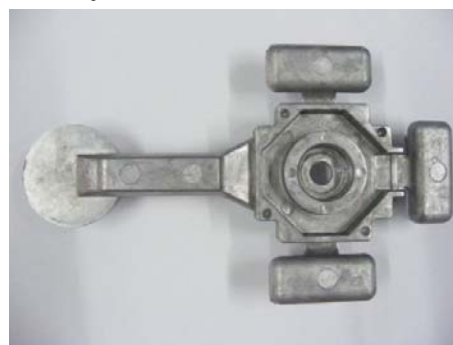
รูปที่ 3.29 แสดงขึ้นงานของอะลูมิเนียมเกรด ADC10 ที่ฉีดขึ้นรูปด้วยเทคโนโลยีโลหะกึ่งของแข็ง
