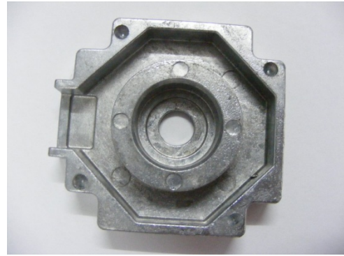
รูปที่ 3.31 แสดงชิ้นงานของอะลูมิเนียมเกรด LM6 ที่ผลิตขึ้นรูปด้วยเทคโนโลยีโลหะกึ่งของแข็ง
