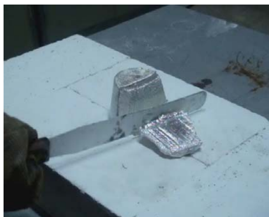
รูปที่ 3.5 แสดงการใช้พายในการตัดก้อนโลหะกึ่งของแข็งที่มีสัดส่วนของแข็งประมาณ 45% ของโลหะอะลูมิเนียมผสมเกรด A356 ที่ผลิตได้จากเครื่อง GISS Version 1.0
