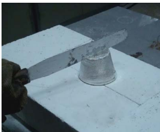
รูปที่ 3.5 แสดงการใช้พายในการตัดก้อนโลหะกึ่งของแข็งที่มีสัดส่วนของแข็งประมาณ 45% ของโลหะอะลูมิเนียมผสมเกรด A356 ที่ผลิตได้จากเครื่อง GISS Version 1.0
