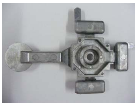
รูปที่ 3.30 แสดงขึ้นงานของอะลูมิเนียมเกรด ADC12 ที่ฉีดขึ้นรูปด้วยเทคโนโลยีโลหะกึ่งของแข็ง
