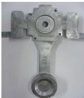
รูปที่ 3.28 แสดงขึ้นงานของอะลูมิเนียมเกรด A356 ที่ฉีดขึ้นรูปด้วยเทคโนโลยีโลหะกึ่งของแข็ง
