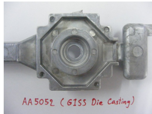
รูปที่ 3.32 แสดงชิ้นงานของอะลูมิเนียมเกรด A5052 ที่ผลิตขึ้นรูปด้วยเทคโนโลยีโลหะกึ่งของแข็ง
