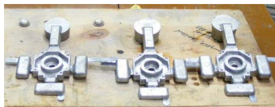
รูปที่ 3.27 แสดงการฉีดขึ้นรูปงานตัวอย่างจากอุตสาหกรรมด้วยเทคโนโลยีโลหะกึ่งของแข็ง
