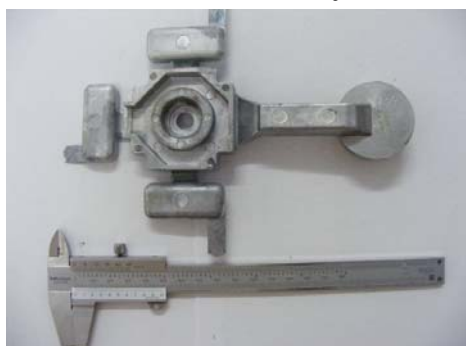
รูปที่ 3.30 แสดงขึ้นงานของอะลูมิเนียมเกรด ADC12 ที่ฉีดขึ้นรูปด้วยเทคโนโลยีโลหะกึ่งของแข็ง
