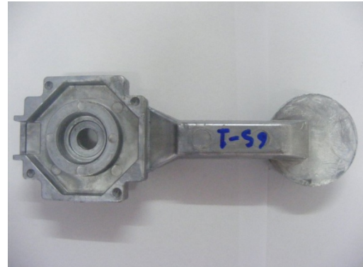
รูปที่ 3.33 แสดงชิ้นงานของอะลูมิเนียมเกรด A6061 ที่ผลิตขึ้นรูปด้วยเทคโนโลยีโลหะกึ่งของแข็ง
