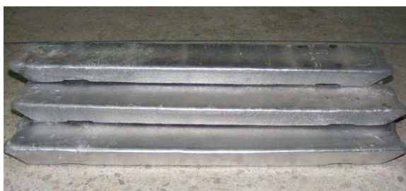
รูปที่ 2.1 แสดงแท่งอะลูมิเนียมผสมเกรด A356 ที่ใช้ในการวิจัยครั้งนี้
