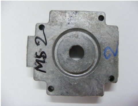
รูปที่ 3.31 แสดงชิ้นงานของอะลูมิเนียมเกรด LM6 ที่ผลิตขึ้นรูปด้วยเทคโนโลยีโลหะกึ่งของแข็ง
