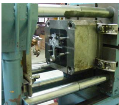
รูปที่ 3.27 แสดงการฉีดขึ้นรูปงานตัวอย่างจากอุตสาหกรรมด้วยเทคโนโลยีโลหะกึ่งของแข็ง
