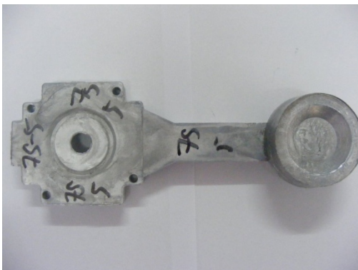
รูปที่ 3.34 แสดงชิ้นงานของอะลูมิเนียมเกรด A7075 ที่ผลิตขึ้นรูปด้วยเทคโนโลยีโลหะกึ่งของแข็ง
