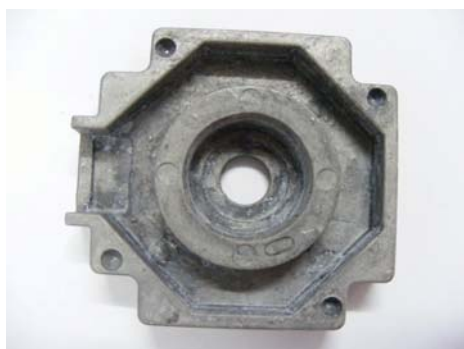
รูปที่ 3.37 แสดงผิวของชิ้นงานที่ผ่านการหล่อผลิตขึ้นรูปด้วยน้ำโลหะแบบธรรมดา ภายหลังจากการนำชิ้นงานไปอบในเตาอบที่อุณหภูมิ 520°C เป็นเวลา 3 ชั่วโมง
