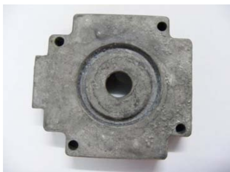
รูปที่ 3.37 แสดงผิวของชิ้นงานที่ผ่านการหล่อผลิตขึ้นรูปด้วยน้ำโลหะแบบธรรมดา ภายหลังจากการนำชิ้นงานไปอบในเตาอบที่อุณหภูมิ 520°C เป็นเวลา 3 ชั่วโมง
