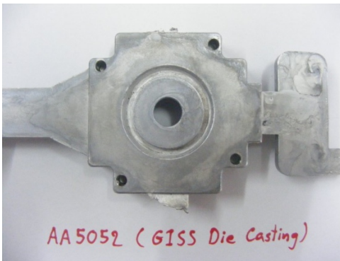
รูปที่ 3.32 แสดงชิ้นงานของอะลูมิเนียมเกรด A5052 ที่ผลิตขึ้นรูปด้วยเทคโนโลยีโลหะกึ่งของแข็ง
