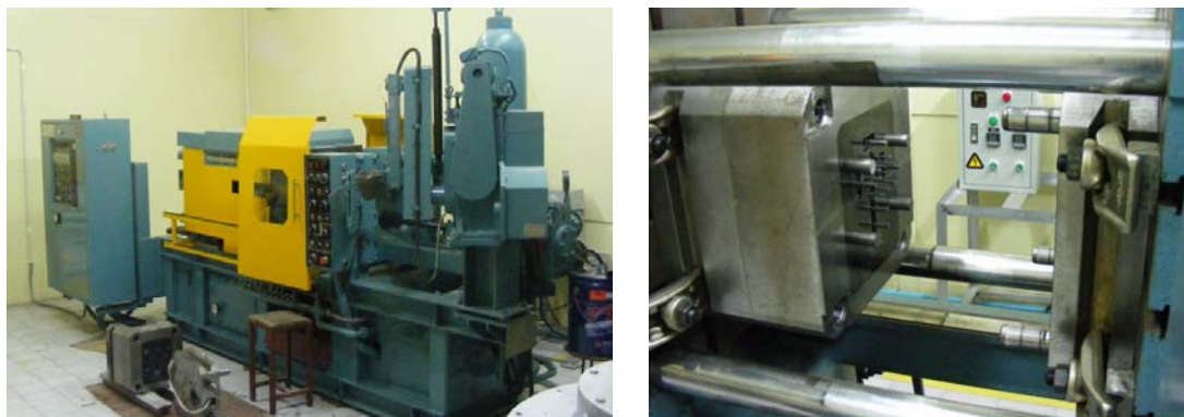
รูปที่ 2.5 เครื่องหล่ออัดฉีดไดคาสติงขนาด 80 ตัน และแม่พิมพ์สำหรับการหล่ออัดฉีดขึ้นรูปชิ้นงานด้วยเทคโนโลยีโลหะกึ่งของแข็ง
