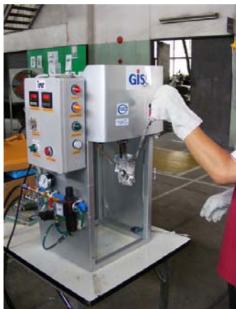
รูปที่ 3.4 แสดงการนำเข้าสู่เตาเผาที่ตักน้ำโลหะจากเตาหลอมมาจุ่มแท่งกราฟไฟต์และปล่อยฟองแก๊สเพื่อผลิตโลหะกึ่งของแข็งตามปริมาณสัดส่วนของแข็งที่ต้องการ
