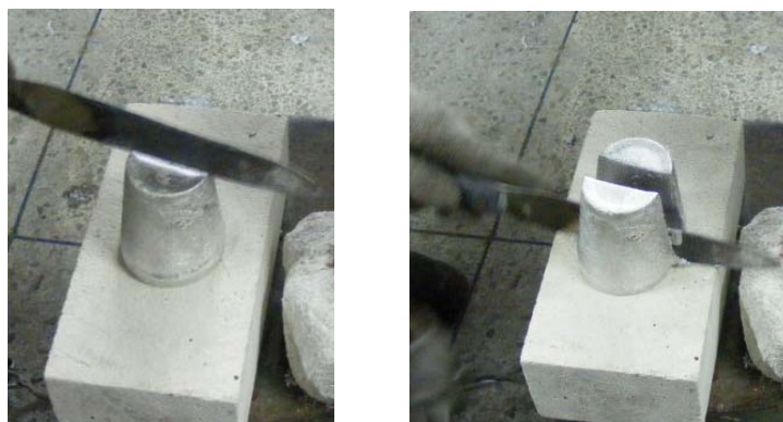
รูปที่ 2.6 แสดงตำแหน่งที่ใช้พาย (Spatula) ผ่าก้อนโลหะกึ่งของแข็ง
