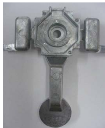
รูปที่ 3.28 แสดงขึ้นงานของอะลูมิเนียมเกรด A356 ที่ฉีดขึ้นรูปด้วยเทคโนโลยีโลหะกึ่งของแข็ง
