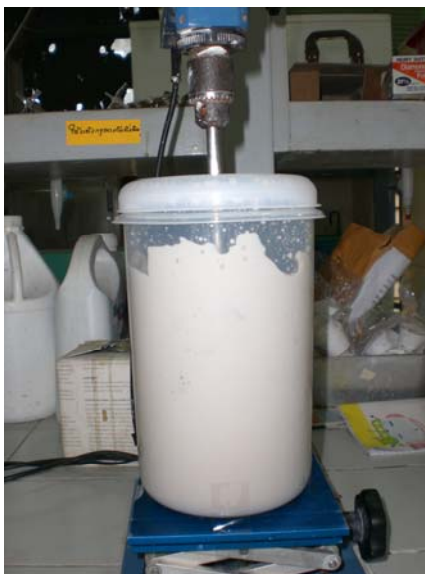
รูปที่ 2.21 การกวนเคลย์ด้วยเครื่องกวนแบบใช้ใบพัด
