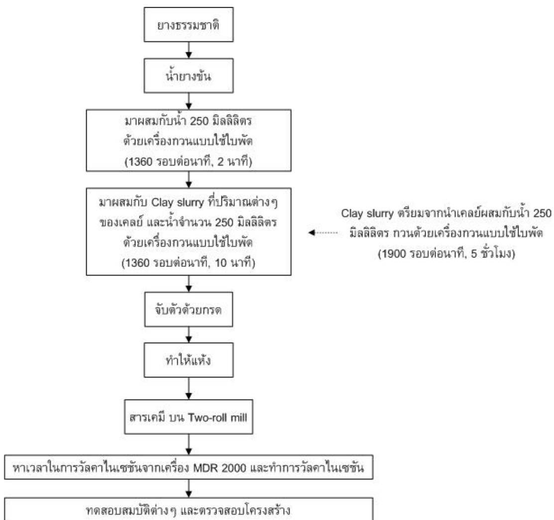
รูปที่ 2.23 ขั้นตอนการเตรียมชิ้นงานยางธรรมชาติที่ผสมเคลย์ ที่ปริมาณต่างๆ
