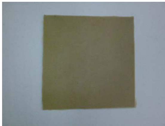
รูปที่ 2.11 ตัวอย่างชิ้นงานหนา 1 มิลลิเมตร สำหรับยางที่ไม่มีการผสมสารตัวเติม
