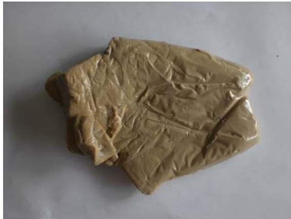
รูปที่ 2.7 ตัวอย่างของยางคอมปาวด์ที่ไม่มีการผสมสารตัวเติม
